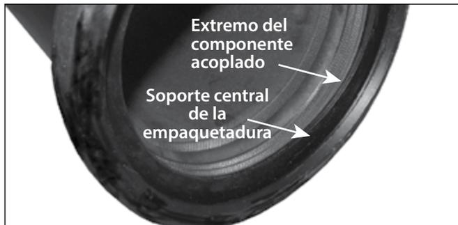
**2. INSTALE LA EMPAQUETADURA:** Inserte el extremo ranurado del componente acoplado en la empaquetadura hasta que tope con el soporte central de la misma.
