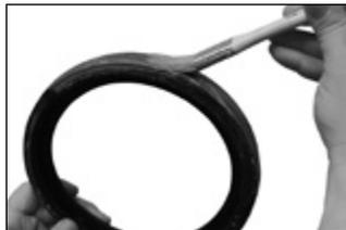
**3. PARA REINSTALAR ACOPLES ESTILO 356, LUBRIQUE LA EMPAQUETADURA:** Aplique una capa delgada de lubricante Victaulic a los labios de sello de la empaquetadura y al exterior. Es normal que la superficie de la empaquetadura tenga una apariencia blanca nebulosa después de haber estado en servicio.
