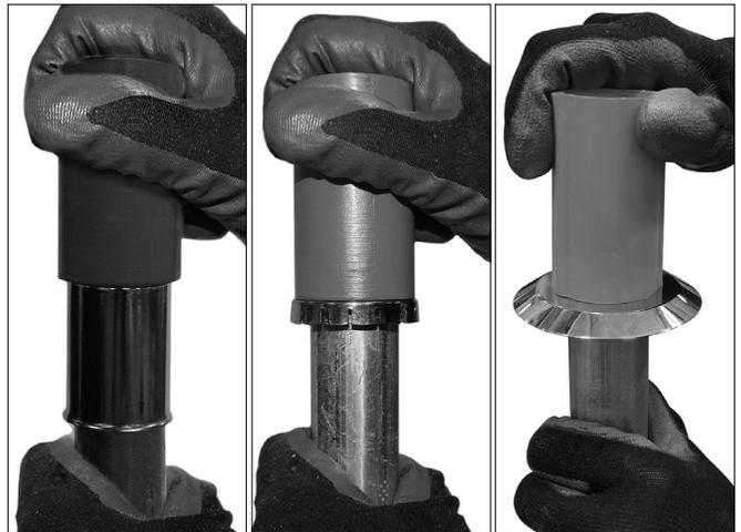
**3.** Empleando la herramienta suministrada, presione hacia abajo el manguito, el collarín empotrado o la placa a ras lo suficiente hasta que quede retenida en la ranura del cilindro. Proceda con precaución al usar esta herramienta para no dañar el bulbo, el deflector ni los brazos del marco.
