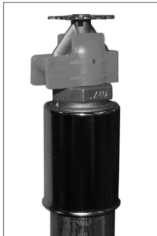
**4.** Reinstale el protector del bulbo en el rociador para proteger el bulbo durante la instalación del rociador. Proceda con precaución al reinstalar el protector del bulbo para no dañar el bulbo, el deflector ni los brazos del marco. NO use herramientas para reinstalar el protector del bulbo. **Los rociadores que muestren indicios de daños se deben reemplazar de inmediato.**
