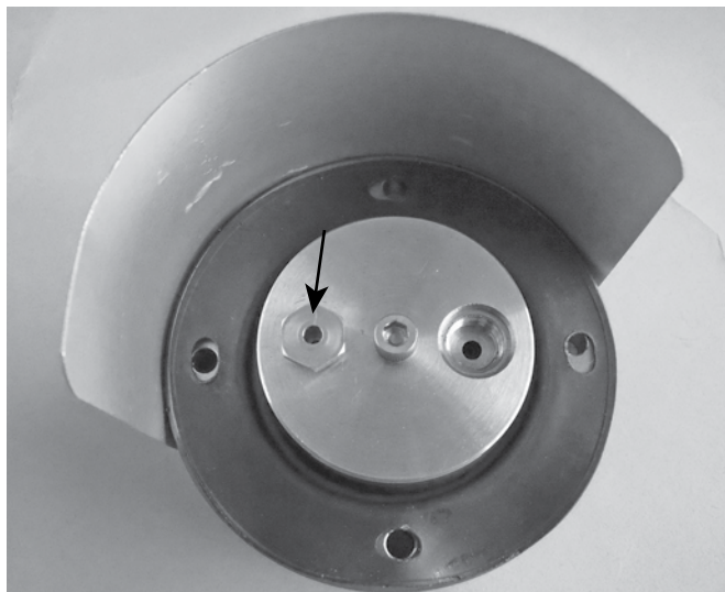
14. Serrare la vite di carico nel pistone per bloccare il limitatore di flusso.
