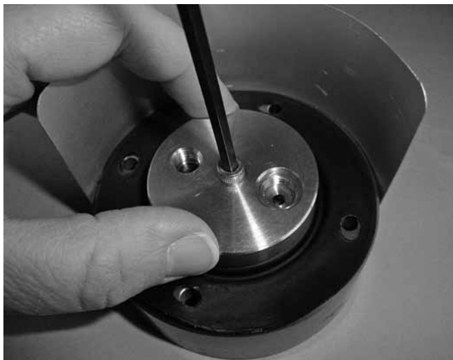
12. Inserire la vite nell'albero dell'attuatore e nel pistone. Usando una chiave esagonale da \frac{3}{4} di pollice, serrare la vite. NOTA: fare attenzione che il gruppo pistone/diaframma non ruoti durante il serraggio della vite.
