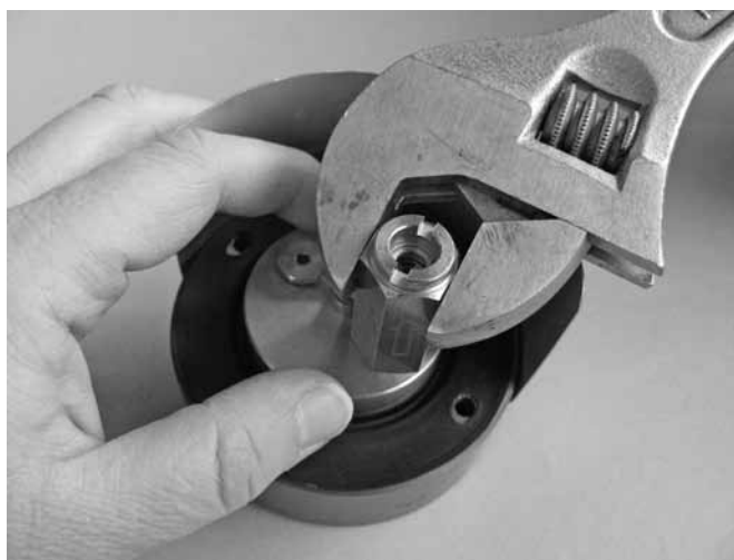
16. Usando una chiave regolabile, installare nel pistone la NUOVA valvola di non ritorno con l'o-ring.
