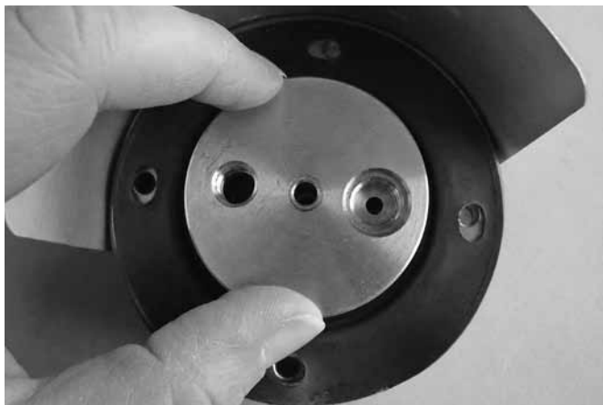
11. Allineare i fori del pistone ai fori del diaframma/albero dell'attuatore.
