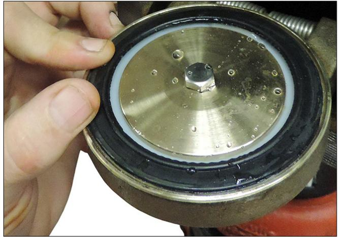
6. Drehen Sie die Klappe aus dem Ventilgehäuse heraus. Überprüfen Sie die Klappendichtung und den Haltering für die Dichtung. Wischen Sie Verunreinigungen, Schmutz und mineralische Ablagerungen ab. Reinigen Sie alle verstopften Löcher im Sitzring des Ventilgehäuses. **VERWENDEN SIE KEINE LÖSUNGS- ODER SCHEUERMITTEL.**
