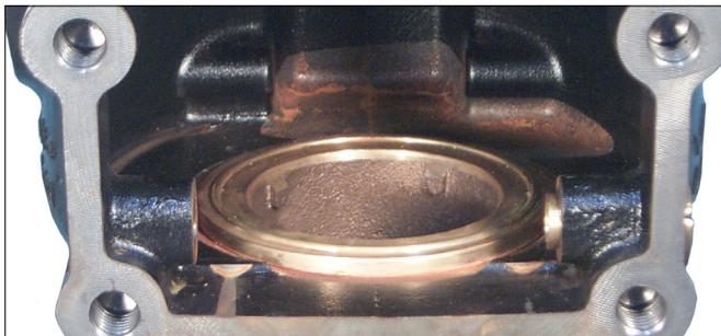
4. Entfernen Sie die Klappenbaugruppe vom Sitzring des Ventilgehäuses. Reinigen Sie alle verstopften Löcher im Sitzring des Ventilgehäuses. **VERWENDEN SIE KEINE LÖSUNGS- ODER SCHEUERMITTEL.**
