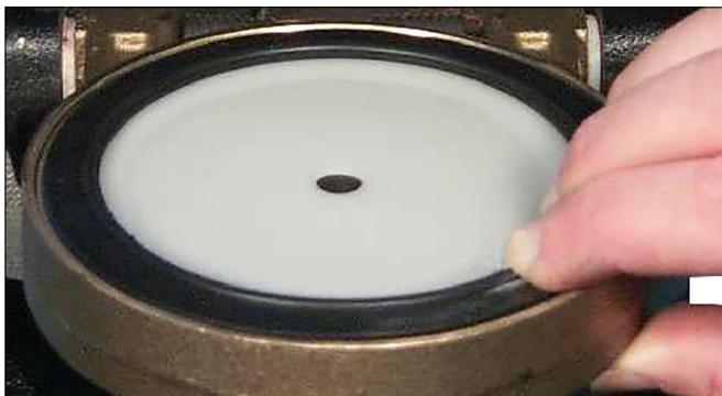
9. Bauen Sie die Klappendichtung sorgfältig in die Klappe ein. **FÜR DIE GRÖSSE 8"/DN200:** Stellen Sie sicher, dass der Dichtungsring ganz in der Klappe einrastet.
