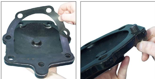
2. Richten Sie die Löcher der Dichtung der Abdeckplatte mit den Löchern in der Abdeckplatte aus.
