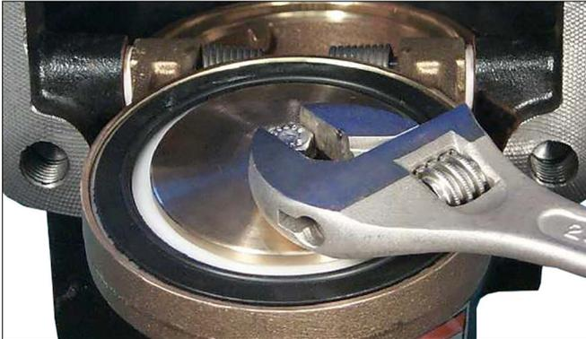
2. Извлеките болт узла уплотнения с уплотнительной шайбой из уплотнения заслонки.
