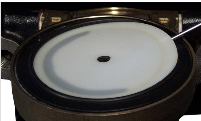
4. Приподнимите за край старую уплотнительную шайбу, чтобы извлечь ее из уплотнения заслонки, как показано выше.
