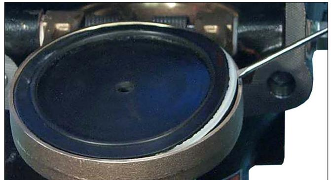
6. Извлеките старое уплотнение заслонки из заслонки. Для размеров 1 ½ – 3-дюйм./DN40 – DN80 и 8-дюйм./DN200: убедитесь, что уплотнительное кольцо снято с уплотнением заслонки. Выбросьте старое уплотнение заслонки и замените его новым, поставляемым Victaulic узлом уплотнения заслонки. Перейдите к шагу 6а для размеров 1 ½ – 3-дюйм./DN40 – DN80 и 8-дюйм./DN200 или к шагу 7 для всех остальных размеров.
