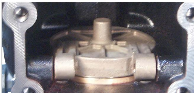
5. Установите новый узел заслонки на кольцо клапанного гнезда корпуса клапана. Убедитесь, что отверстия в штифтах заслонки выровнены с отверстиями на корпусе клапана.
