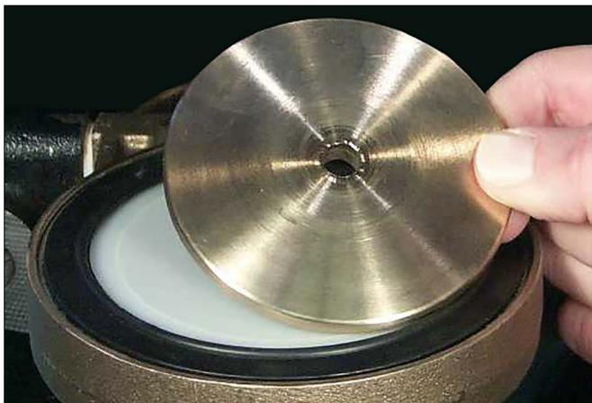
10. Установите стопорное кольцо уплотнения (плоской стороной вниз) на уплотнительную шайбу уплотнения заслонки, как показано выше.
