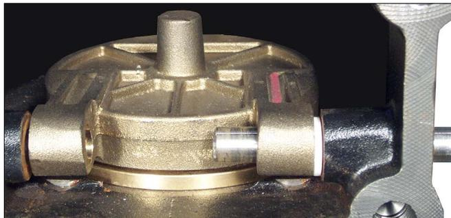
6. Вставьте шток заслонки в корпус клапана и поместите одну разделительную прокладку между заслонкой и корпусом клапана, как показано выше.
