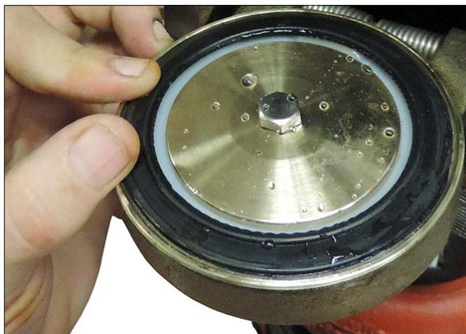
6. Прокрутите заслонку с корпуса клапана. Осмотрите уплотнение заслонки и уплотнительное кольцо. Вытрите все загрязнения, грязь и минеральные отложения. Очистите все отверстия, которые находятся в кольце клапанного гнезда корпуса клапана. **НЕ ИСПОЛЬЗУЙТЕ РАСТВОРИТЕЛИ И АБРАЗИВЫ.**
