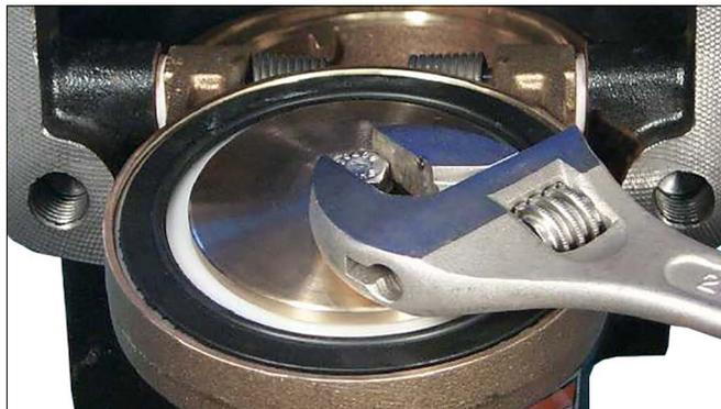
11. Вставьте болт узла уплотнения с уплотнительной шайбой в стопорное кольцо уплотнения и заслонку. Затяните болт узла уплотнения с уплотнительной шайбой. Чтобы обеспечить необходимое уплотнение, момент затяжки болта должен соответствовать значению, указанному в таблице ниже.
