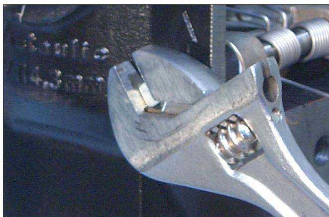
9. Нанесите резьбовой герметик на каждое фиксирующую заглушку штока заслонки. Вставьте фиксирующие заглушки штока заслонки в корпус клапана, завернув до отказа рукой.
