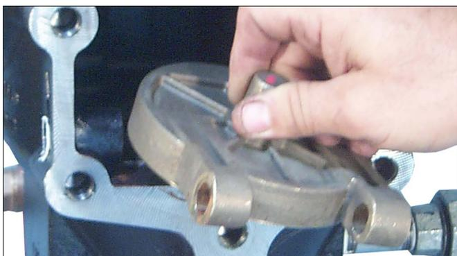
4. Удалите узел заслонки из кольца клапанного гнезда корпуса клапана. Очистите все отверстия, которые находятся в кольце клапанного гнезда корпуса клапана. **НЕ ИСПОЛЬЗУЙТЕ РАСТВОРИТЕЛИ И АБРАЗИВЫ.**
