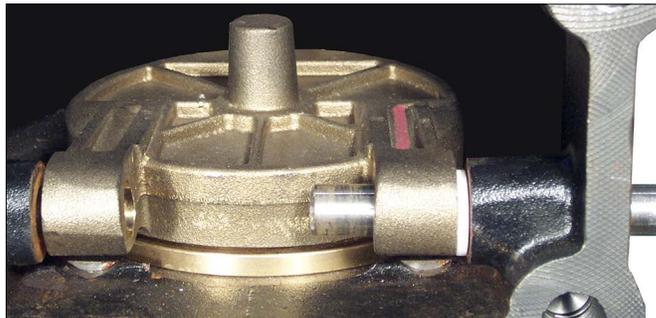
6. Meta el eje de la clapeta en el cuerpo de la válvula y ponga un espaciador entre la clapeta y el cuerpo, como en la ilustración de arriba.
