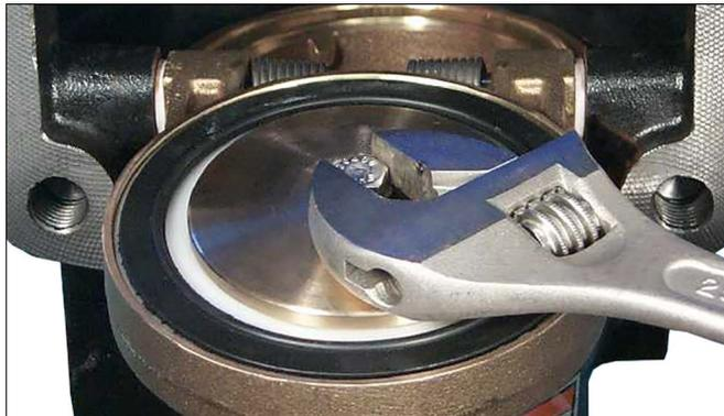
2. Quite el tornillo de la junta del cierre de clapeta.
