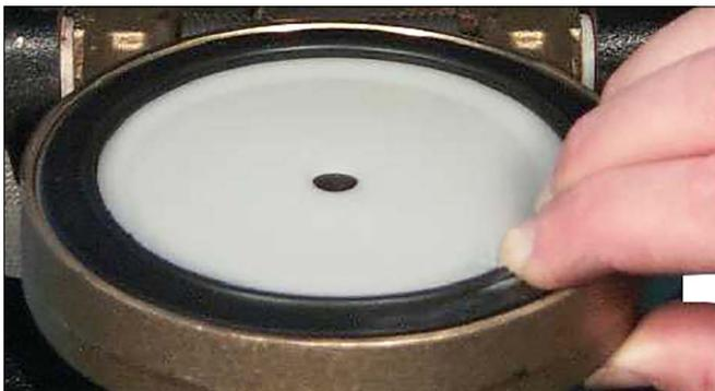
9. Instale el sello en la clapeta con sumo cuidado. **PARA DIÁMETROS DE 1 ½ – 3 PULG/DN40 – DN80 Y 8 PULG/DN200:** Compruebe que el anillo de sellado encaje perfectamente en la clapeta.
