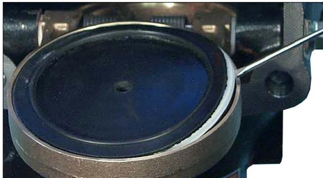
6. Saque el sello viejo de la clapeta. En medidas de 1 ½ – 3 pulg/ DN40 – DN80 y 8 pulg/DN200, verifique que el anillo y salga con el sello. Descarte el sello viejo de la clapeta y cámbielo por otro nuevo de Victaulic. En medidas de 1 ½ – 3 pulg/DN40 – DN80 y 8 pulg/DN200 vaya al paso 6a y para cualquier otra medida, al paso 7.
