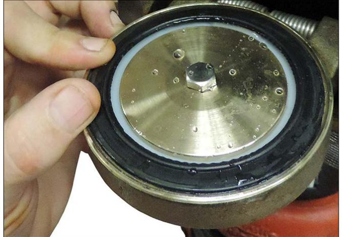
6. Saque girando la clapeta del cuerpo de la válvula. Inspeccione el sellado de la clapeta y el retén de sellado. Retire cualquier contaminante, suciedad o depósito mineral. Limpie todos los agujeros del anillo de sellado del cuerpo de la válvula. **NO USE DISOLVENTES NI PRODUCTOS ABRASIVOS.**
