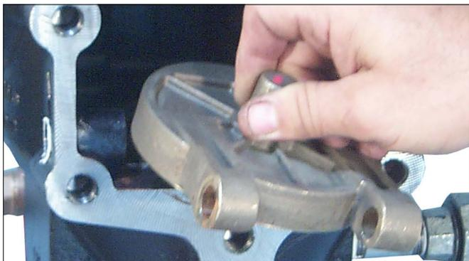
4. Quite el conjunto de clapeta del anillo de asiento del cuerpo de la válvula. Limpie todos los agujeros del anillo de sellado del cuerpo de la válvula. **NO USE DISOLVENTES NI PRODUCTOS ABRASIVOS.**
