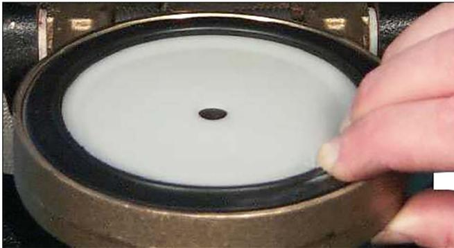
9. Instale cuidadosamente el sello de clapeta en la clapeta. **PARA TAMAÑOS DE 1 ½ – 3 PULG./DN40 – DN80 Y 8 PULG./DN200:** Verifique que el anillo de sello se inserte completamente a presión en la clapeta.
