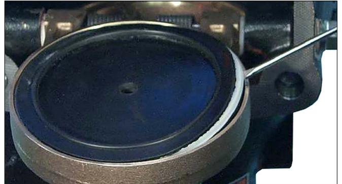
6. Palanquee el sello de clapeta antiguo para quitarlo de la clapeta. Para tamaños de 1 ½ – 3 pulg./DN40 – DN80 y 8 pulg./DN200, verifique que el anillo del sello sea retirado con el sello de la clapeta. Deseche el sello de clapeta antiguo y replácelo por un conjunto de sello de clapeta nuevo suministrado por Victaulic. Continúe en el paso 6a para los tamaños de 1 ½–3 pulg./DN40–DN80 y 8 pulg./DN200 o en el paso 7 para los demás tamaños.
