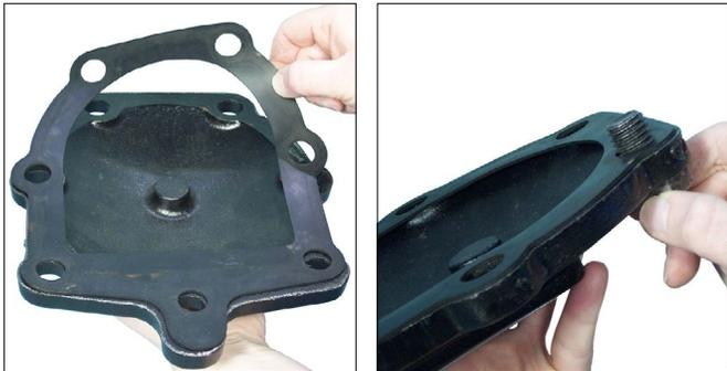
2. Alinee los orificios de la empaquetadura de la cubierta con los orificios de la cubierta.
