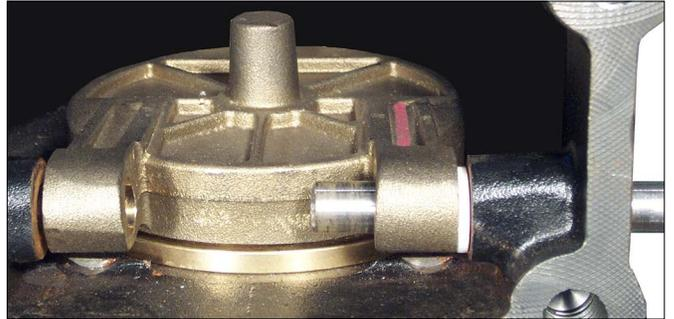
6. Comience a introducir el eje de la clapeta en el cuerpo de la válvula y ponga un espaciador entre la clapeta y el cuerpo de la válvula, como se muestra arriba.
