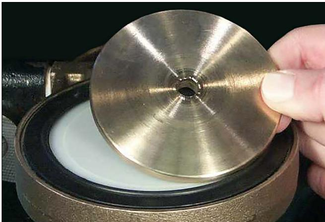
10. Coloque el anillo de retención del sello (con la cara plana hacia abajo) sobre la arandela de sello del sello de la clapeta, como se muestra arriba.
