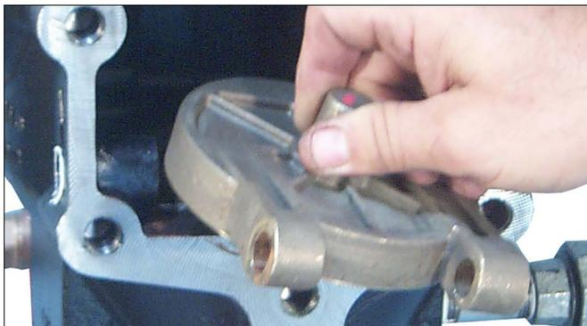
4. Quite el conjunto de clapeta del anillo de asiento del cuerpo de la válvula. Limpie los orificios obstruidos en el anillo del asiento del cuerpo de la válvula. **NO USE DISOLVENTES NI SUSTANCIAS ABRASIVAS.**
