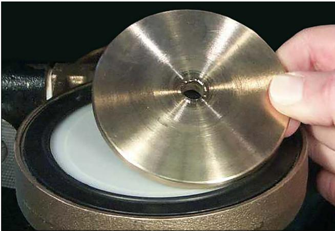
3. Retire el anillo de retención del sello. Guarde el anillo de retención del sello para su reinstalación.
