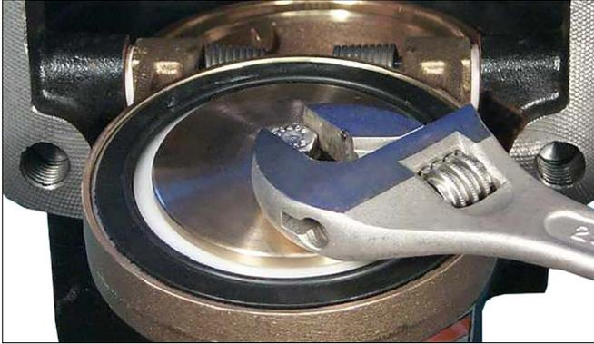
2. Retire el perno de montaje de sello/sello del perno de la clapeta.
