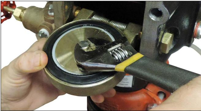
14. Drehen Sie die Klappe aus dem Ventilgehäuse heraus. Entfernen Sie die Schraube der Dichtungsbaugruppe/Schraubendichtung wie oben dargestellt von der Klappendichtung. Entsorgen Sie die Schraube der Dichtungsbaugruppe/Schraubendichtung.
