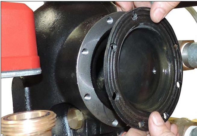
26. Entfernen Sie die Membran vom Ventilgehäuse. Entsorgen Sie die Membran.
