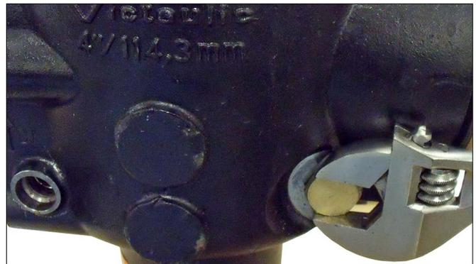
6. Entfernen Sie die Buchsen des Verriegelungschafts vom Ventilgehäuse. Entfernen und entsorgen Sie die O-Ringe der Verriegelungschaftbuchsen. Bewahren Sie die Verriegelungschaftbuchsen für den Wiedereinbau auf.
