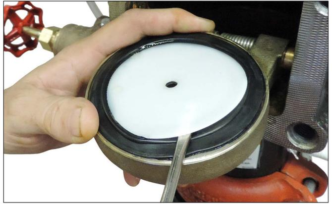
16. Hebeln Sie die Kante der Dichtungsscheibe wie oben dargestellt aus dem Inneren der Klappendichtung heraus. Entfernen und entsorgen Sie die Dichtungsscheibe.
