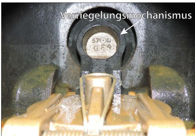
2. Drücken Sie den Verriegelungsmechanismus nach hinten (in Richtung Membran).
