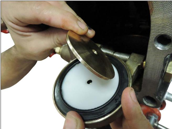
15. Entfernen Sie den Haltering für die Dichtung. Bewahren Sie den Haltering für die Dichtung für den Wiedereinbau auf.
