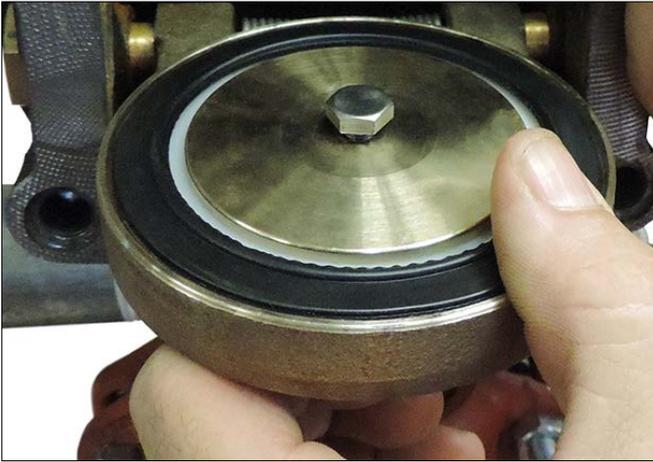
20. Platzieren Sie den Haltering für die Dichtung auf der Dichtungsscheibe der Klappendichtung. Führen Sie die neue Schraube der Dichtungsbaugruppe/Schraubendichtung (im Lieferumfang des Bausatzes enthalten) durch den Haltering für die Dichtung und die Klappe ein.
