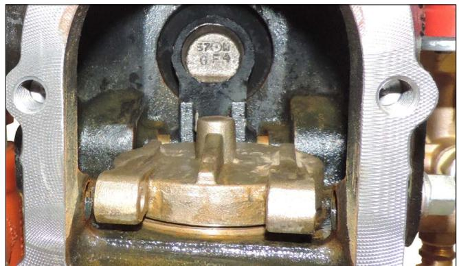
8. Führen Sie den neuen Verriegelungsschaft (im Lieferumfang des Bausatzes enthalten) durch das Ventilgehäuse in den ersten Arm des Verriegelungsmechanismus ein. **VERGEWISSERN SIE SICH, DASS DIE SEITE DES VERRIEGELUNGSMECHANISMUS MIT DER AUSSPARUNG ZUR ÖFFNUNG DES VENTILS ZEIGT. DIE FLACHE SEITE DES VERRIEGELUNGSMECHANISMUS MUSS WIE OBEN DARGESTELLT ZUR MEMBRAN ZEIGEN.**
