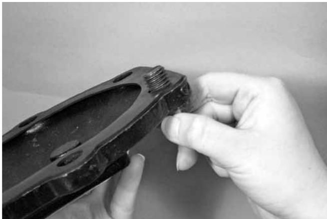
3. Insérer un boulon de plaque-couvercle dans la plaque, ainsi que dans le joint d'étanchéité plat, pour faciliter l'alignement. **NOTE** : dans les diamètres de 1 1/2 pouce/48,3 mm et 2 pouces/60,3 mm, une rondelle doit être installée sous la tête de chacun des boulons de plaque-couvercle des clapets.
