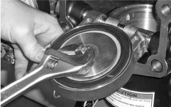
11. Serrer l'ensemble boulon de joint/joint de boulon au couple indiqué dans le tableau ci-dessous pour assurer une bonne étanchéité.
