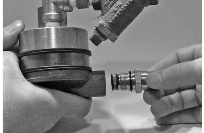
3. Retirer le filtre de l'actionneur basse pression série 776, comme illustré ci-dessus. Mettre uniquement le tamis du filtre au rebut.
