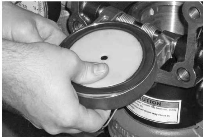
9. Installer avec soin le joint de disque dans le disque. S'assurer que la bague d'étanchéité se cale bien en place dans le disque.
