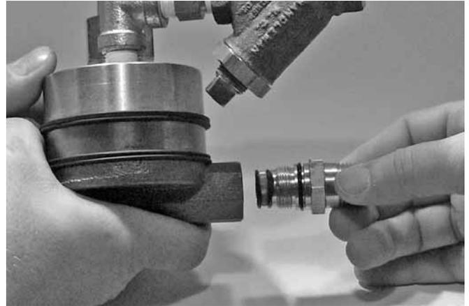
3. Den Filtersatz wie oben abgebildet vom Niederdruckantrieb der Serie 776 abnehmen. Nur das Filtersieb entsorgen.
