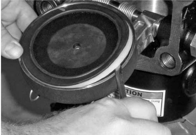
6. Die Klappendichtung zusammen mit dem Dichtungsring aus der Klappe hebeln. Die Klappendichtung überprüfen. Wenn die Klappendichtung zerrissen oder verschlissen ist, durch eine neue, von Victaulic gelieferte Klappendichtung ersetzen. Wenn die gesamte Klappendichtung ausgewechselt wird, mit Schritt 7 fortfahren.
