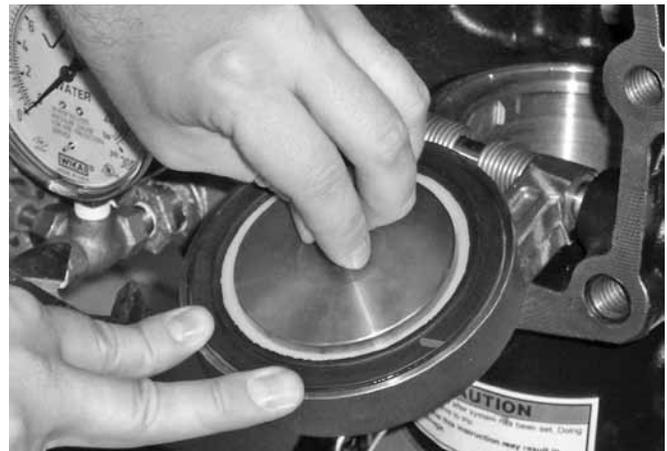
10. Den Haltering für die Dichtung auf die Dichtungsscheibe der Klappendichtung legen. Die Montageschraube für den Haltering der Dichtung festziehen.
