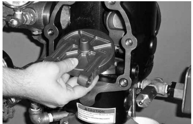
4. Die Klappe aus dem Gehäuse der Ventilstation herausnehmen.
