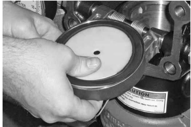
9. Die Klappendichtung vorsichtig in die Klappe einsetzen. Sicherstellen, dass der Dichtungsring ganz in die Klappe einrastet.
