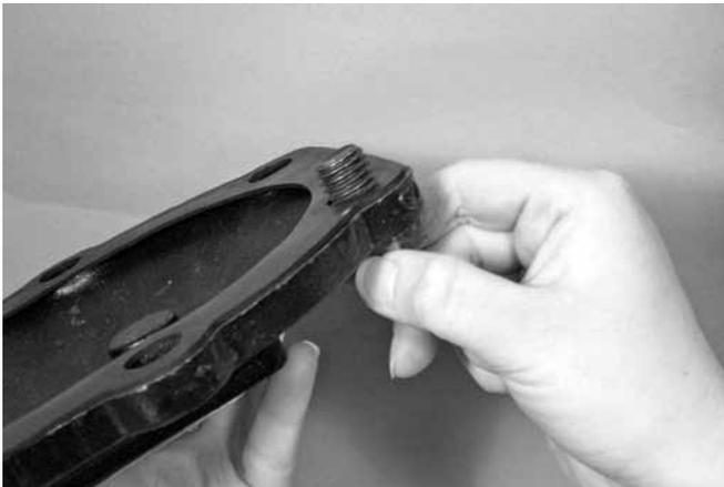
3. Stecken Sie eine Abdeckungsschraube durch die Abdeckung und deren Dichtung, um die Ausrichtung zu erleichtern. **ANMERKUNG:** Bei den Ventilgrößen 1½-Zoll/48,3-mm und 2-Zoll/60,3-mm muss beim Wiedereinbau eine Unterlegscheibe unter den Kopf jeder Abdeckungsschraube gelegt werden.
