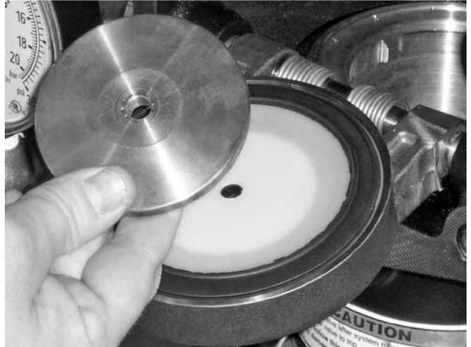
3. Den Haltering für die Dichtung abnehmen.
