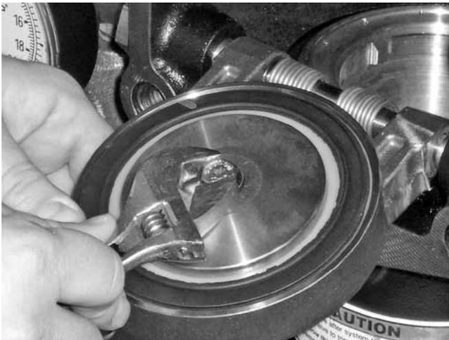
2. Die Montageschraube für den Haltering von der Klappendichtung abnehmen.
