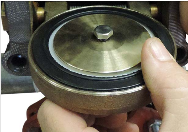
10. 将密封定位环放到阀瓣密封的密封垫片上。将密封装配螺栓/螺栓密封装入密封定位环和阀瓣中。
