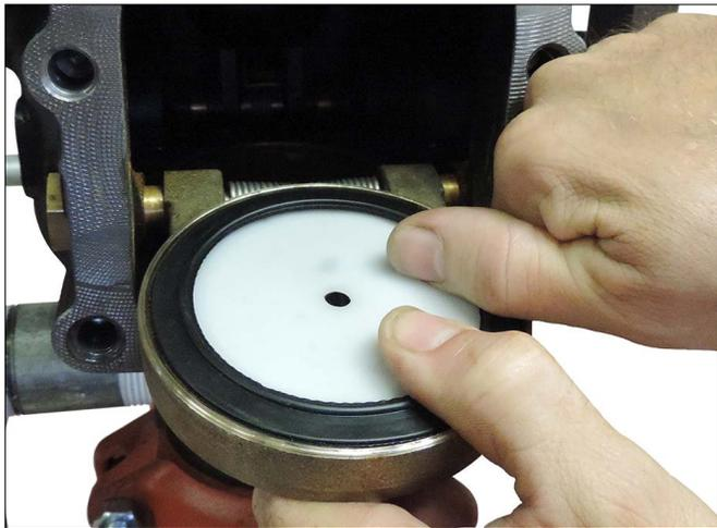
9. Poser avec soin le joint de clapet à battant dans le clapet à battant. Confirmer que l'anneau d'étanchéité s'insère complètement dans le clapet à battant.
