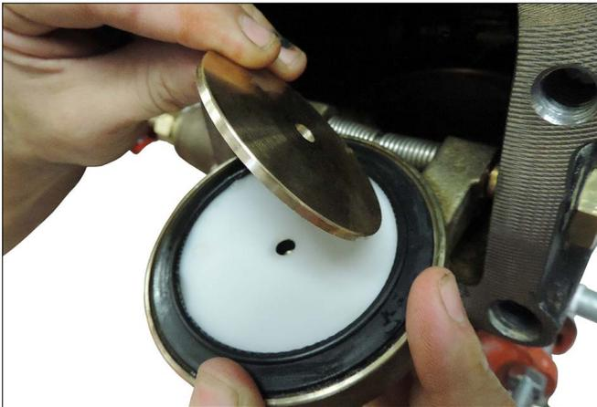
3. Déposer le disque de retenue du joint d'étanchéité. Garder le disque de retenue du joint d'étanchéité pour la repose.
