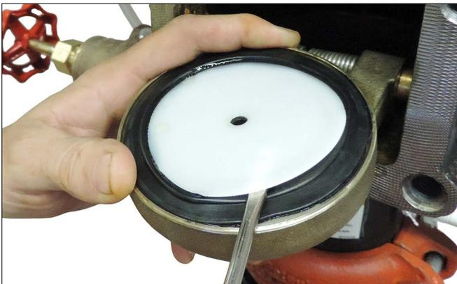
4. Faire levier sur le rebord de la rondelle d'étanchéité depuis l'intérieur du joint de clapet à battant, comme montré ci-dessus. **NE PAS FAIRE LEVIER SUR LA RONDILLE D'ÉTANCHÉITÉ À PARTIR DE SON TROU CENTRAL.**
