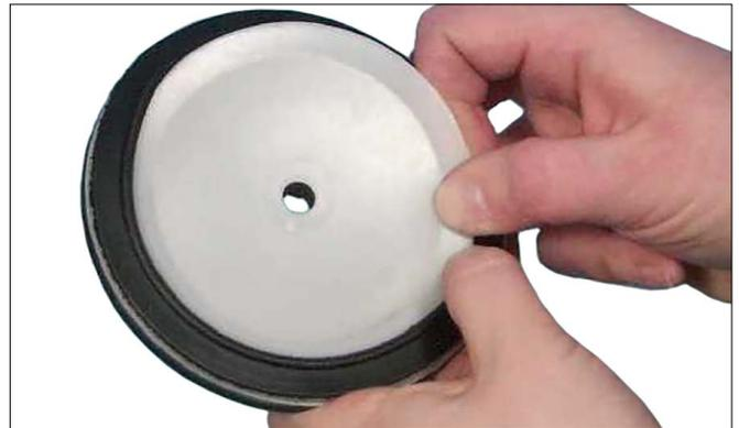
7. Insérer soigneusement la rondelle d'étanchéité sous la lèvre du joint d'étanchéité.
