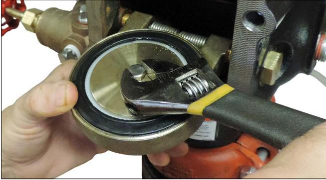
2. Déposer le boulon de retenue du joint d'étanchéité du clapet à battant.
