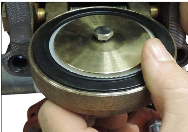
10. Placer le disque de retenue du joint d'étanchéité sur la rondelle d'étanchéité du joint de clapet à battant. Insérer le boulon d'assemblage du joint (avec rondelle d'étanchéité sous la tête) dans le disque de retenue du joint d'étanchéité et le clapet à battant.
