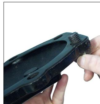
2. Aligner les trous du joint d'étanchéité du couvercle avec les trous du couvercle.
