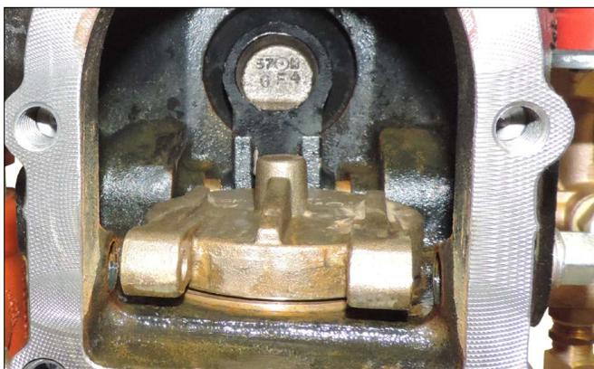
5. Posizionare il nuovo gruppo clapet nell'anello di sede del corpo della valvola. Verificare che i fori dei bracci del clapet siano allineati con quelli nel corpo valvola.
