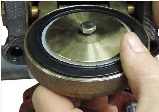
10. Posizionare l'anello di fissaggio nella rondella di tenuta del clapet. Inserire il bullone di assemblaggio/tenuta del bullone nella ghiera di tenuta e nel clapet.
