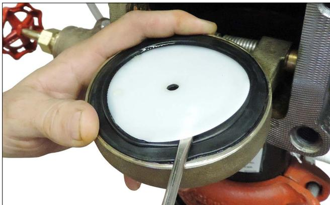
4. Sollevare il bordo della rondella di tenuta dall'interno della tenuta del clapet, come illustrato sopra. **NON SOLLEVARE LA RONDELLA DI TENUTA FUORI DAL FORO PIÙ INTERNO.**
