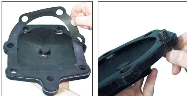
2. Allineare i fori della guarnizione della piastra di copertura con i fori nella piastra di copertura.
