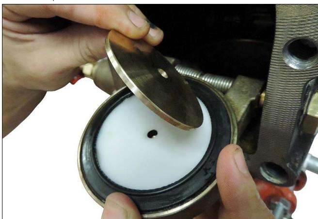
3. Rimuovere la ghiera di tenuta. Conservare l'anello di fissaggio per il rimontaggio.
