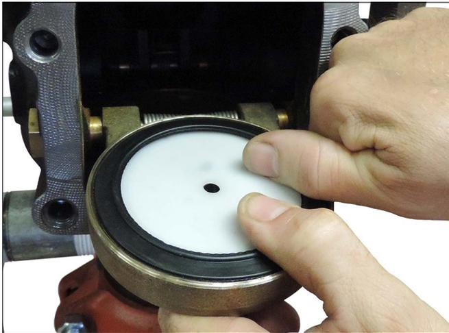
9. Installare delicatamente la tenuta clapet nel clapet. Verificare che l'anello di tenuta scatti in posizione all'interno del clapet.
