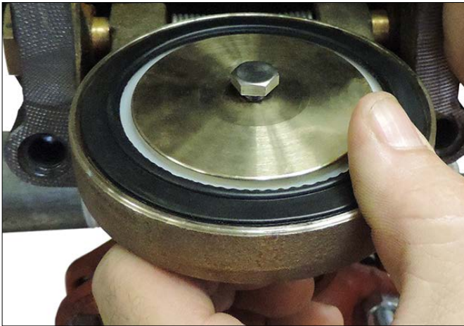
10. 기밀(Seal) 고정 링을 클래퍼 기밀(Seal)의 기밀(Seal) 와셔 위에 장착합니다. 기밀(Seal) 어셈블리 볼트/볼트 기밀(Seal)을 기밀(Seal) 고정 링과 클래퍼를 통해 설치합니다.
