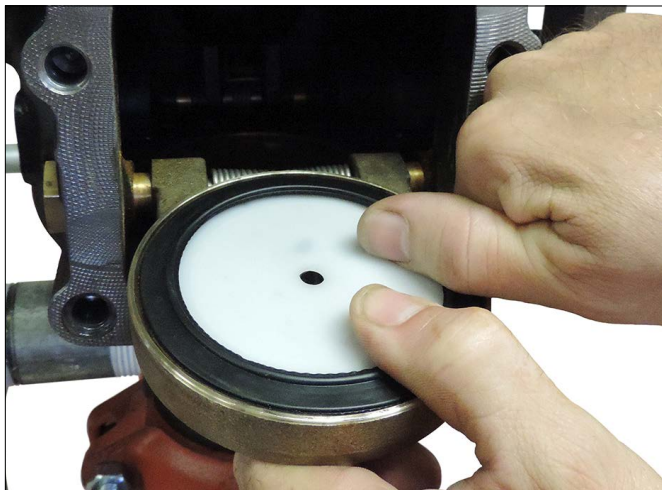
9. 小心地將閥瓣密封裝入閥瓣中。確認密封環完全扣入閥瓣中。
