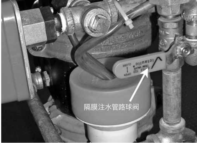
7. 关闭隔膜注水管路球阀。
