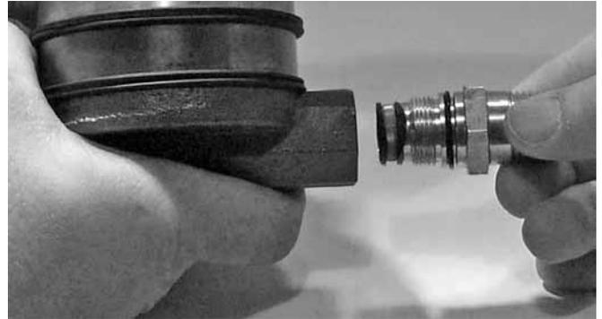
3. Quite el conjunto del filtro del actuador neumático/neumático Serie 798, como se ve arriba. Deseche solamente la pantalla del filtro.
