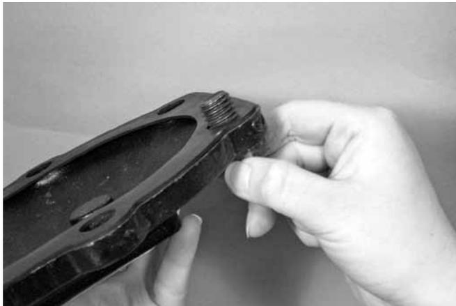
3. Introduzca un perno en la tapa y en la junta de la tapa para facilitar la alineación. **NOTA:** En las válvulas de 1 ½ pulg/48,3 mm y de 2 pulg/60,3 mm hay que poner arandelas en cada uno de los pernos de la tapa.
