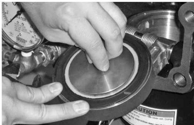
10. Coloque el retén de sellado sobre la arandela de la junta del cierre de clapeta. Pase el perno de sellado a través del retén y la clapeta.
