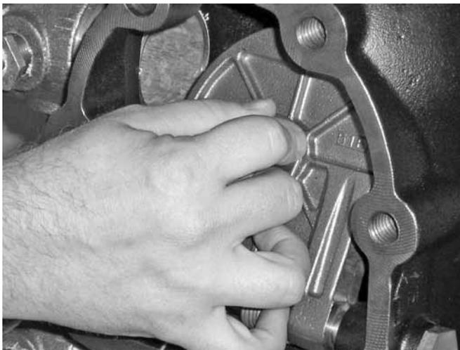
14. Verifique que la clapeta se mueve libremente y no está deteriorada. Sustituya cualquier pieza estropeada o desgastada siguiendo las instrucciones del capítulo "Mantenimiento".
