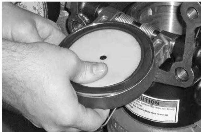
9. Instale con cuidado la junta del cierre de clapeta en la clapeta. Asegúrese de que el anillo de sellado entra completamente en la clapeta.
