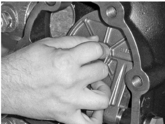
14. Inspeccione si la clapeta se mueve libremente y si presenta daños físicos. Reemplace todas las partes dañadas o desgastadas siguiendo las instrucciones correspondientes de la sección "Mantenimiento".
