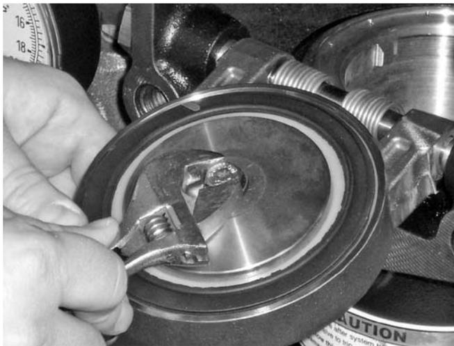
2. Retire el montaje de sello del perno/sello del perno de la clapeta.
