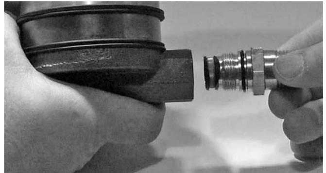
3. Retire el conjunto de filtro del actuador neumático/neumático Serie 798, como se muestra arriba. Deseche sólo la malla del filtro.
