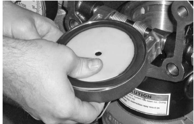
9. Con cuidado, instale el sello en la clapeta. Asegúrese de que el anillo de sello encaje por completo en la clapeta.
