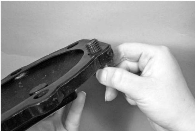
3. Inserte un perno a través de la tapa para rociador oculto y la empaquetadura para facilitar el alineamiento. **NOTA:** En los tamaños de válvula de 1 ½ pulg./48,3 mm y 2 pulg./60,3 mm, se deben reinstalar las arandelas bajo las cabezas de los pernos de la tapa para rociador oculto.
