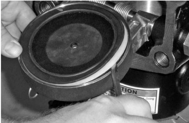
6. Palanquee el sello de la clapeta, junto con el anillo de sello, y retírelo de la clapeta. Inspeccione el sello de la clapeta. Si el sello de la clapeta está roto o gastado, reemplácelo por otro suministrado por Victaulic. Si reemplaza el conjunto de sello de la clapeta por otro nuevo, salte al paso 7.
