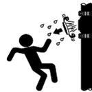
En effet, si on ôte les boulons alors que le clapet est encore sous pression, la plaque-couvercle peut être projetée violemment, entraînant des blessures graves et/ou d'importants dommages matériels.
