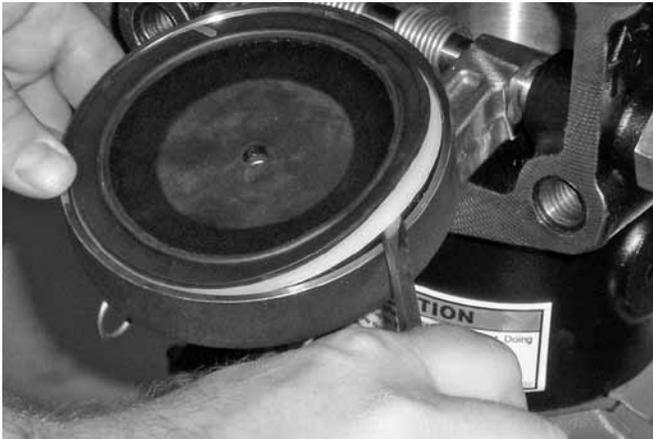
6. Sortir du disque le joint de disque, ainsi que la bague d'étanchéité, en faisant levier. Inspecter le joint. Si le joint de disque est déchiré ou usé, le remplacer par un neuf, fourni par Victaulic. En cas de remplacement du joint de disque par un neuf, passer à l'étape 7.
