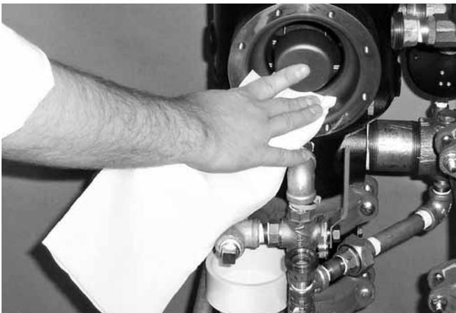
5. Nettoyer l'arrière du corps du clapet afin d'ôter les débris qui pourraient nuire à une bonne assise de la membrane.
