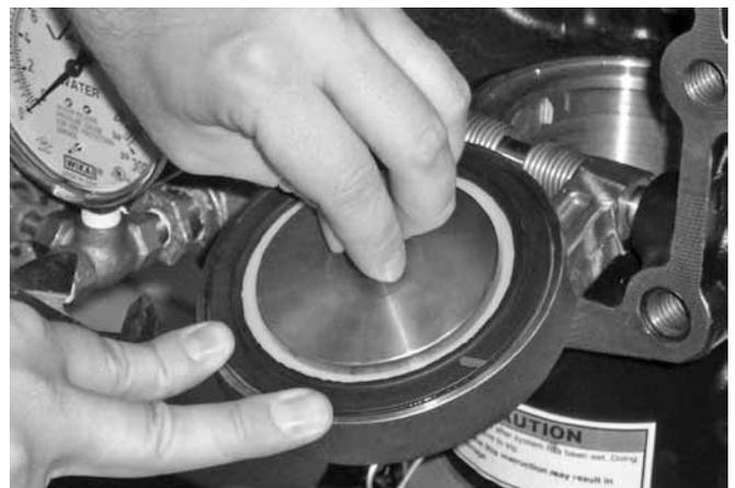
10. Placer l'anneau de retenue du joint sur la rondelle de joint du joint de disque. Installer l'ensemble boulon de joint/joint de boulon en l'enfilant dans l'anneau de retenue du joint et le disque.
