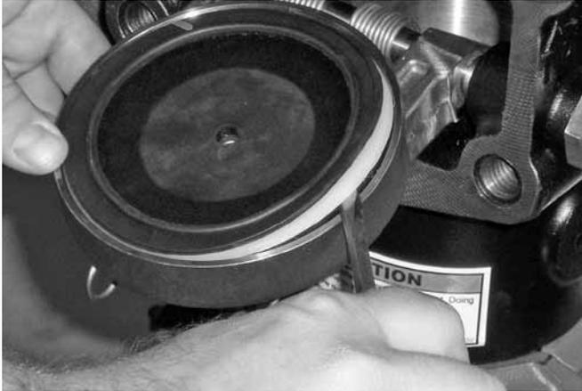
6. 將閥瓣密封連同密封環從閥瓣上撬出。檢查閥瓣密封。如果閥瓣密封撕裂或磨損，請用一個唯特利提供的新閥瓣密封更換。如果利用一個新的元件替換閥瓣密封元件，請跳至第7步。
