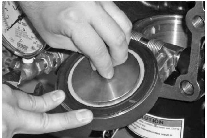
10. 將密封定位環置於閥瓣密封的密封墊片上。穿過密封定位環和閥瓣，安裝密封裝配螺栓/螺栓密封墊。
