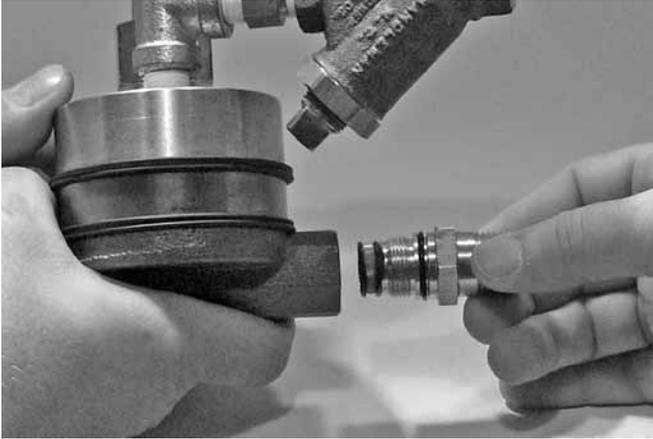
3. 從776系列低壓執行機構上拆下過濾器組件，如上圖所示。僅丟棄過濾器濾網。
