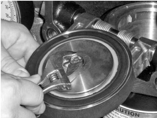
2. 從閥瓣密封上拆下密封裝配螺栓/螺栓密封墊。
