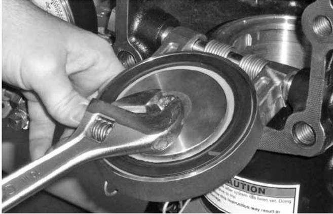
11. 擰緊密封裝配螺栓/螺栓密封墊至下表所列扭矩值，以確保達到正確密封效果。
