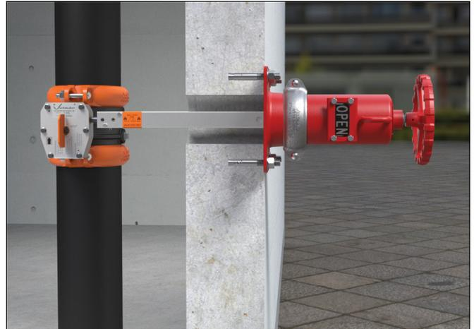
9. Drehen Sie das Handrad der horizontalen Stellungsanzeige, um die ordnungsgemäße Funktion der Absperrklappe zu überprüfen. Vergewissern Sie sich, dass die mit „OPEN“ markierte Fläche vollständig im Fenster sichtbar ist, wenn die Klappe in ganz geöffneten Stellung ist, und dass die mit „SHUT“ markierte Fläche vollständig im Fenster sichtbar ist, wenn die Klappe in ganz geschlossener Stellung ist.
