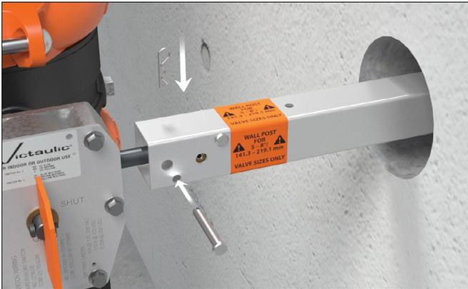
7. Ziehen Sie das Verlängerungsrohr auf die Antriebsmutter und stecken Sie den Gabelbolzen durch die Löcher am Ende des Verlängerungsrohrs. Bringen Sie den Splint am Ende des Gabelbolzens an. Vergewissern Sie sich, dass das Verlängerungsrohr vollständig in die Antriebsmutter eingreift und nicht von der Mutter abgezogen werden kann.
