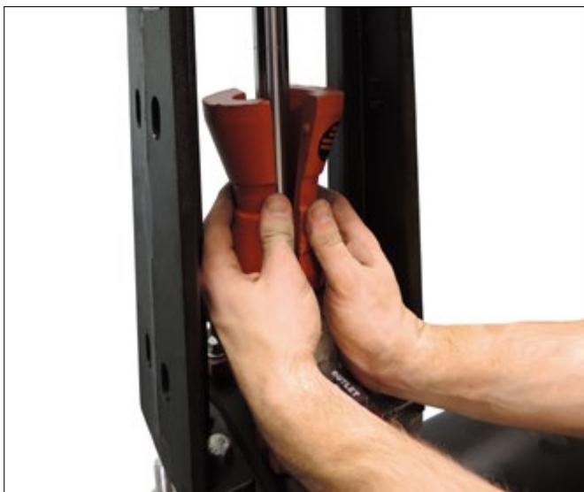
**2b.** Retirer le collier de serrage à boulon en T et séparer les deux moitiés du limiteur de course à enlever.
