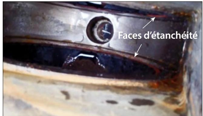
**8. NETTOYER LA VANNE :** s'assurer que la cavité du siège et le robinet de vidange sont exempts de débris en rinçant la cavité à l'eau. Essuyer les faces d'étanchéité avec un chiffon ou une brosse.
