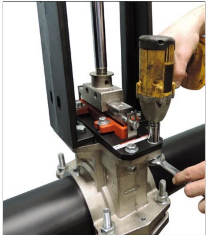
**4. RETIRER ET REPLACER LES VIS DU CONNECTEUR D'OBTURATEUR :** retirer les deux vis à tête hexagonale du connecteur d'obturateur. Les replacer sur la patte de chaque côté du siège et dans le côté de la guillotine avant de les serrer à la main. Cela est nécessaire pour attacher le siège à la guillotine pendant le retrait aux étapes ultérieures.
