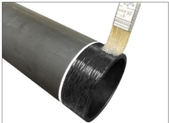
**5. LUBRIFIER LES EXTRÉMITÉS DE TUBE :** appliquer une mince couche de lubrifiant sur l'extrémité du tube depuis le bout du tube jusqu'à la marque tracée à l'étape 4.
