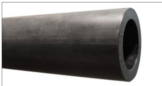
**2. INSPECTER LES EXTRÉMITÉS DES TUBES :** vérifier que les extrémités des tubes sont bien propres, en parfait état et sans rayures sur une longueur de 2 ½ pouces/64 mm à partir du bord. Toute trace d'huile, de graisse, de saleté et de particules de rainurage par enlèvement doit être éliminée. Le non-respect de cette consigne pourrait entraîner des difficultés de montage et un défaut d'étanchéité.
