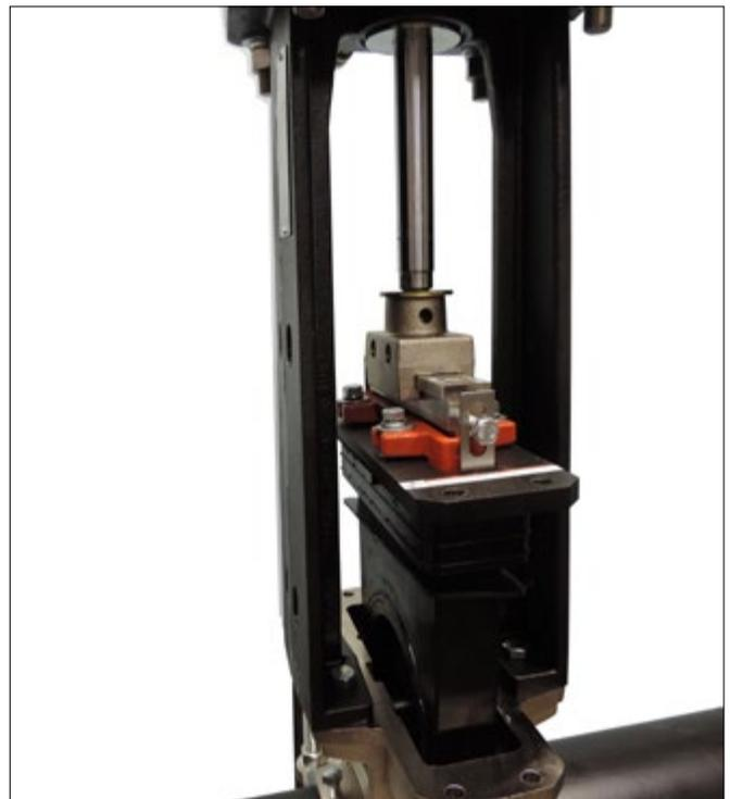
**6b.** Pour les vannes à actionnement pneumatique ou hydraulique, actionner la vanne ouverte pour tirer le siège hors du corps de la vanne.
