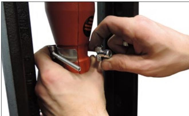
**2a.** À l'aide d'une clé à douille profonde de  $\frac{7}{16}$ "/11 mm, retirer l'écrou sur le collier de serrage à boulon en T et écarter le collier de serrage.
