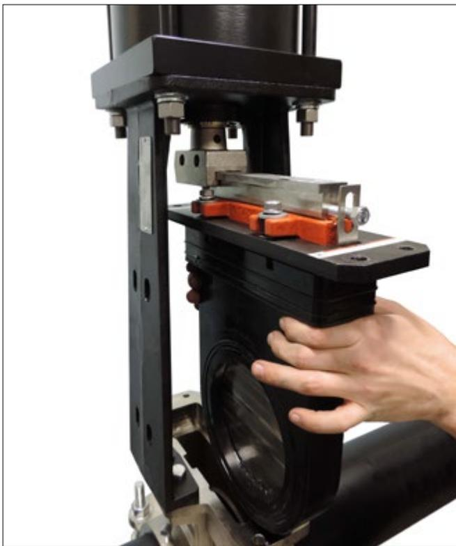
**7. RETIRER LA CARTOUCHE :** lorsque le siège est écarté de l'ouverture du corps de la vanne, faire coulisser la cartouche de siège hors de la fente du connecteur d'obturateur, comme illustré ci-dessus. Pour les mesures de dégagement, se reporter à la dimension « E » dans le tableau en page 11.
