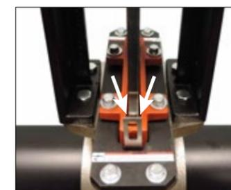
**9. LÜCKE ÜBERPRÜFEN:** Betätigen Sie das Handrad (oder die pneumatische oder hydraulische Betätigung), um das Schieberblatt aus dem Armaturengehäuse heraus anzuheben. Stellen Sie sicher, dass die Lücke auf beiden Seiten des Schieberblatts gleich ist. Die Sechskantschrauben der Stopfbuchse können bei Bedarf verstellt werden, um eine gleich große Lücke auf beiden Seiten des Schieberblatts zu erzielen. Siehe die Montage- und Wartungsanleitung für weitere Informationen.
