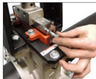
**4. SCHRAUBEN FÜR VERBINDUNGSTÜCK DES SCHIEBERS ABNEHMEN UND NEU ANBRINGEN:** Nehmen Sie die beiden Sechskantschrauben vom Verbindungsstück des Schiebers ab. Stecken Sie sie durch die Zunge an beiden Seiten des Sitzes und in die Seite des Schieberblatts ein und ziehen Sie sie dann von Hand an. Das ist notwendig, damit der Sitz beim Abnehmen in den späteren Schritten am Schieberblatt befestigt werden kann.
