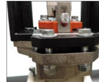
**3b.** Bei pneumatisch oder hydraulisch betätigten Armaturen bringen Sie die Armatur in die geschlossene Stellung, um den Sitz zum Armaturengehäuse hin zu bringen.
