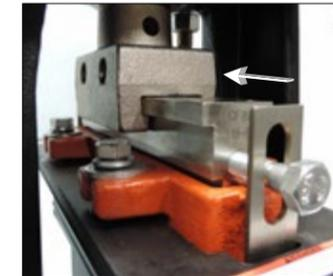
**2. PATRONE EINSETZEN:** Schieben Sie die Dichtungspatrone in die Öffnung im Verbindungsstück des Schiebers hinein.
