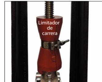
**2. RETIRE EL LIMITADOR DE CARRERA:** Retire el limitador de carrera para levantar el vástago completamente. Utilizando una llave de dado largo de 7/16 pulg./11 mm, retire la tuerca de la abrazadera del perno en "T" y separe la abrazadera. Retire la abrazadera del perno en "T" y separe ambos segmentos del limitador de carrera para extraerlo.
