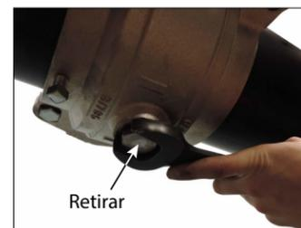
**3. QUITE EL TAPÓN:** Usando una llave de 1 1/4 pulg./32 mm (para válvulas de 3 a 8") o una llave de 1 1/2 pulg./38 mm (para válvulas de 10 a 12"), quite el tapón de la parte inferior del cuerpo de la válvula.
