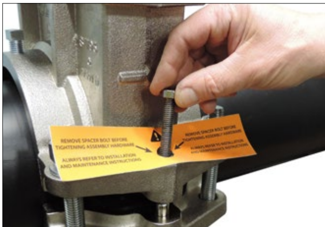
5c. KUN AVSTANDSBOLTENE SKAL FJERNES: Det sitter en avstandsbolt i hver boltblokk for å opprettholde avstanden mellom boltblokkene under frakt og sammenmontering. Når røret er satt inn, skal kun avstandsboltene med advarslslappene fjernes før de fire mutrene strammes i trinn 6.
