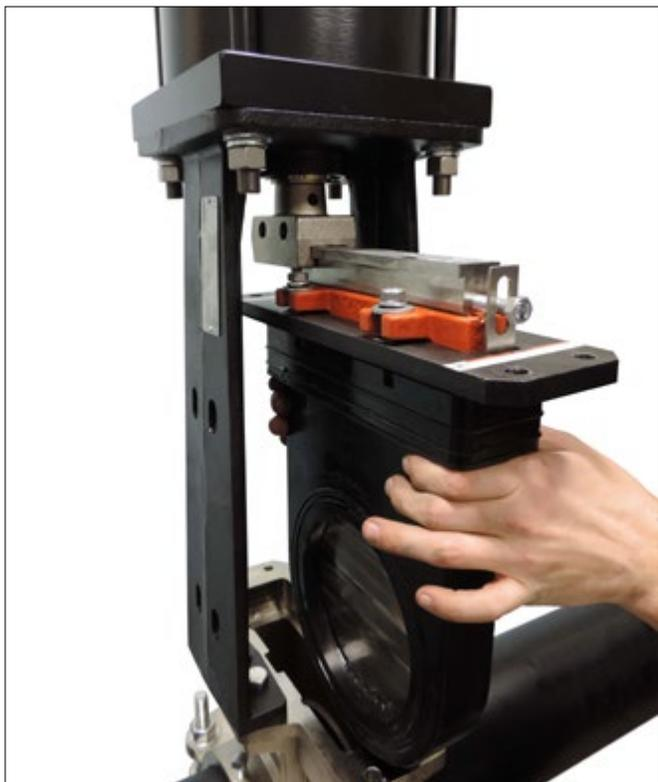
**7. REMOVER O CARTUCHO:** Quando o apoio tiver liberado a abertura do corpo da válvula, deslize o cartucho de apoio para fora do encaixe no conector de porta, como mostrado acima. Para medidas de espaçamento, consulte a dimensão E na tabela da página 11.
