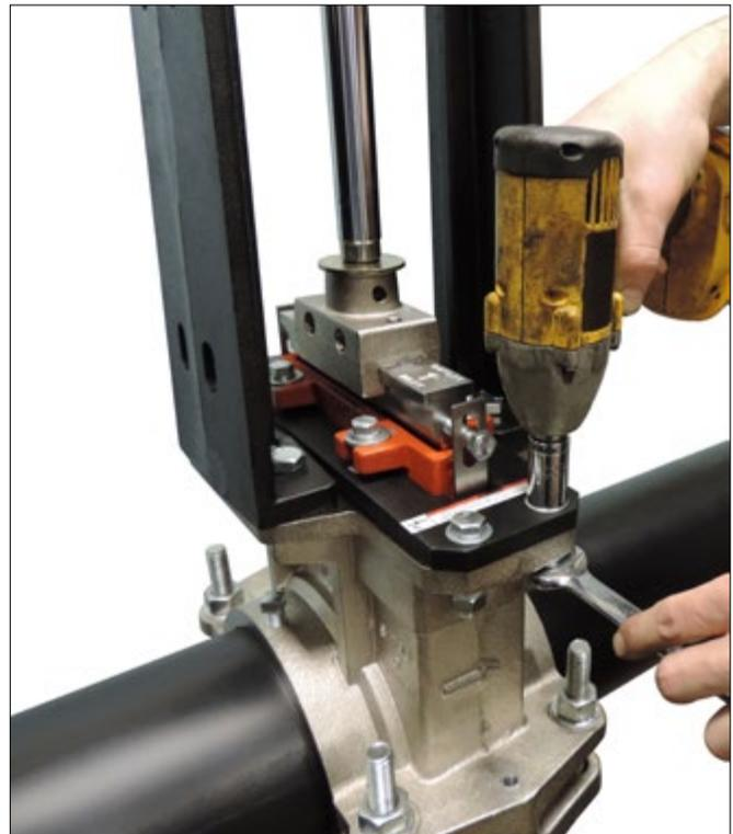
**4. REMOVER E RECOLOCAR OS PARAFUSOS DO CONECTOR DE PORTA:** Remova os dois parafusos de Tampa hexagonal do conector de porta. Realoque-os através da guia em cada lado do assento e no lado da faca e então aperte manualmente. Isto é necessário a fim de acoplar o apoio à faca durante a remoção em etapas posteriores.
