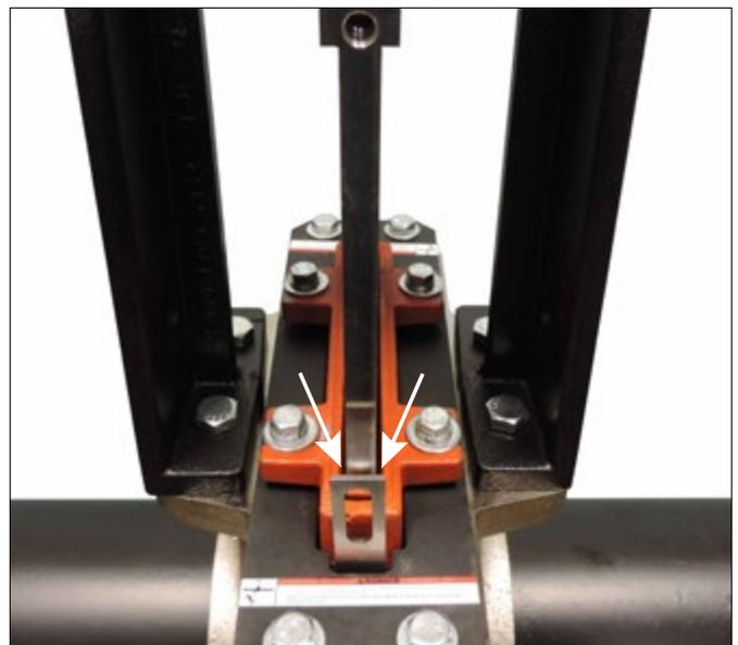
**9. INSPECIONAR LACUNA:** Opere o volante (ou o operador pneumático ou hidráulico) para levantar a face para fora do corpo da válvula. Assegure que a lacuna em ambos os lados da face seja igual, como mostrado acima. Os parafusos de tampa hexagonais da gaxeta de embalagem podem ser ajustados, se necessário, para obter uma lacuna igual em ambos os lados da face. Consulte a seção "Ajuste de embalagem" na página 24 para rever o ajuste dos parafusos de tampa hexagonais.
