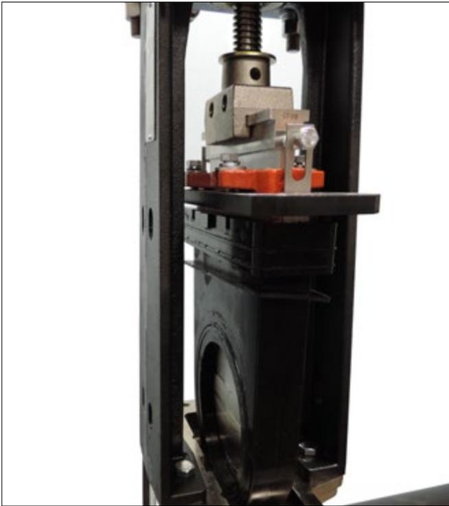
**6a. ABRIR VÁLVULA:** Para válvulas operadas por volante, inicie a operação com o volante na direção "aberta" (sentido anti-horário) para tirar o apoio do corpo da válvula.
