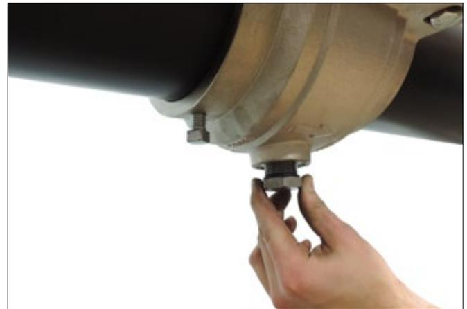
**2a.** Use uma chave de soquete longo de  $\frac{7}{16}$  polegada/11 mm e remova a porca no grampo do parafuso em T e puxe o grampo.
