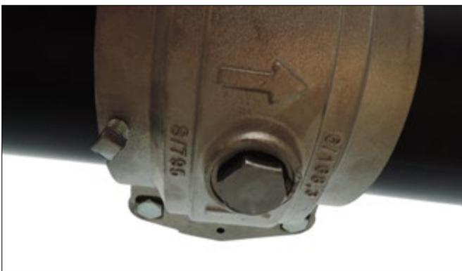
**7. SUBSTITUIR O PLUGUE:** Substitua o plugue no fundo do corpo da válvula, apertando o plugue como mostrado no gráfico abaixo.
