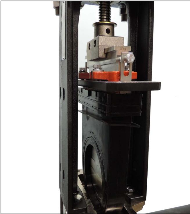
**6a. ABRA LA VÁLVULA:** Para válvulas accionadas por volante, gire el volante hacia la posición "abierto" (opuesto al reloj) para retirar el asiento del cuerpo de la válvula.
