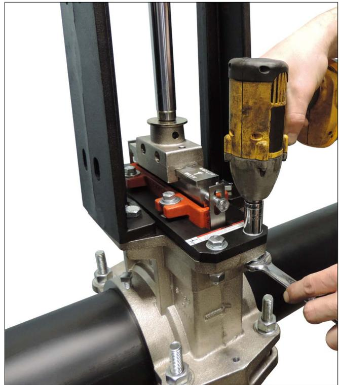
**4. RETIRE Y REPOSICIONE LOS TORNILLOS DEL CONECTOR DE COMPUERTA:** Retire los dos tornillos de casquete hexagonal del conector de compuerta. Reubíquelos a través de la lengüeta a cada lado del asiento e insértelos en el costado de la cuchilla, luego apriételos con la mano. Esto es necesario para fijar el asiento a la guillotina para retirarlo en pasos posteriores.
