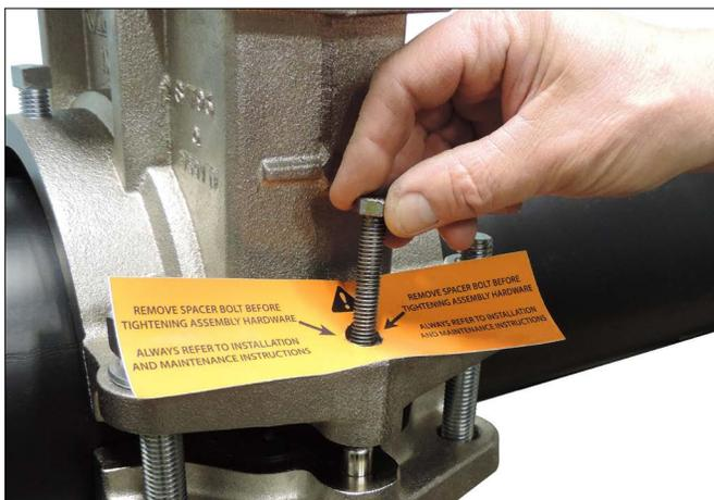
**5c. RETIRE ÚNICAMENTE LOS PERNOS ESPACIADORES:** Hay un perno espaciador en cada cierre emperrado para mantener la distancia en el cierre durante el despacho y el montaje. Después de insertar la tubería, retire únicamente los pernos espaciadores y las etiquetas de advertencia antes de apretar las cuatro tuercas según indica el paso 6.
