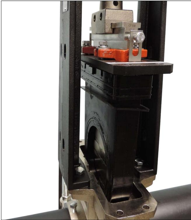
**3a. CIERRE LA VÁLVULA:** Para válvulas accionadas por volante, gire lentamente el volante a la posición “cerrada” (en el sentido del reloj) para acercar el asiento al cuerpo de la válvula. Procure que la lengüeta del asiento quede orientada hacia la ranura en el cuerpo de la válvula, como se muestra en el paso 1. Para evitar daños a las superficies del asiento, no accione el volante con demasiada rapidez, ni tampoco utilice un taladro o pistola de impacto.
