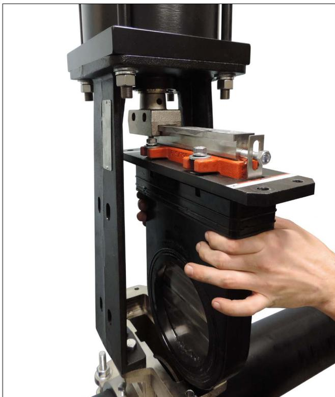
**7. RETIRE EL CARTUCHO:** Cuando el asiento haya salido de la abertura del cuerpo de la válvula, deslice el cartucho de asiento para retirarlo desde la ranura en el conector de compuerta, como se muestra arriba. Para conocer las mediciones de distancia, consulte la dimensión E en la tabla de la página 11.
