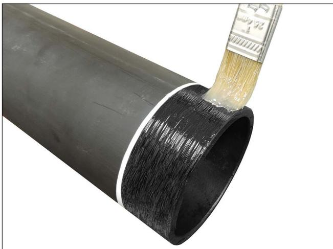
**5. LUBRIQUE EL EXTREMO DE TUBERÍA:** Aplique una capa delgada de lubricante en la tubería desde el extremo hasta la marca de pintura trazada en el paso 4.
