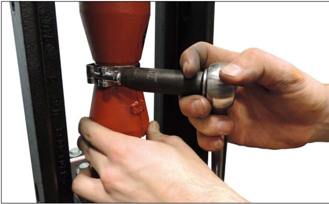
2a. Utilizando una llave de dado largo de  $\frac{7}{16}$  pulg./11 mm, retire la tuerca de la abrazadera del perno en "T" y separe la abrazadera.
