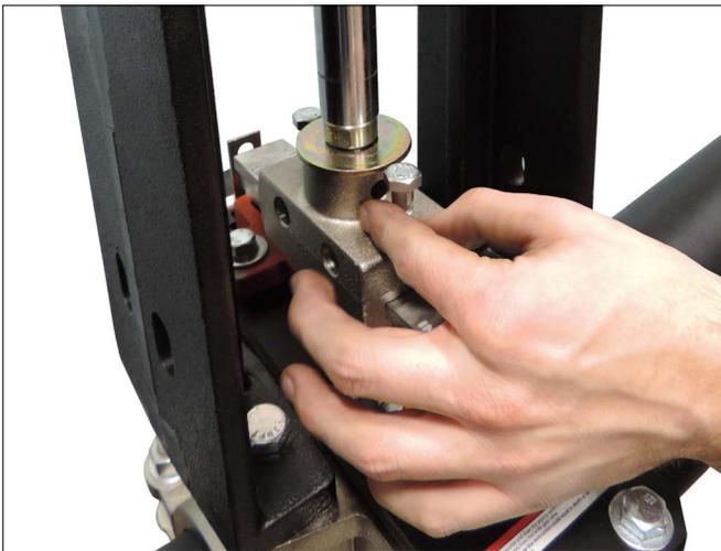
**6. RETIRE Y REPOSICIONE LOS TORNILLOS DEL CONECTOR DE DE COMPUERTA:** Quite los dos pernos de casquete hexagonal de la guillotina y reposiciónelos en el conector de compuerta, como se muestra arriba. Asegúrese de que el tornillo de casquete hexagonal se enrosque de tal modo que la cabeza quede bajo la arandela (página 5, componente 12).
