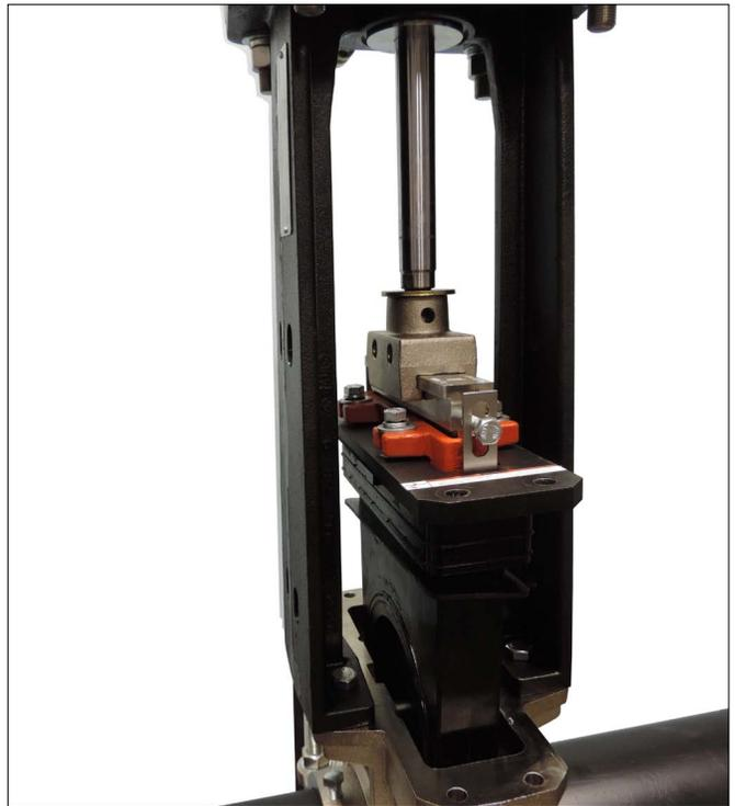
**6b.** Para válvulas de accionamiento neumático o hidráulico, accione la válvula para abrirla y retire el asiento del cuerpo.
