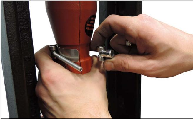
2b. Retire la abrazadera del perno en "T" y separe ambos segmentos del limitador de carrera para extraerlo.
