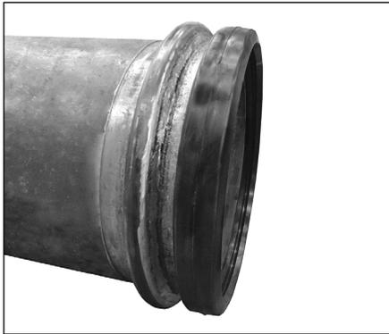
**2. 放置密封垫圈：** 将密封垫圈套在一个管端上，直到密封垫圈的中心脚接触管端为止。
