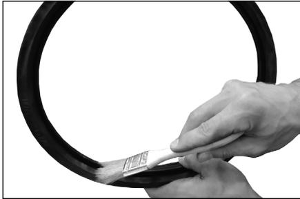
**1. 检查密封垫圈并进行润滑：** 检查密封垫圈，确认其适合既定工况。色码标明了密封垫圈的等级。如需色码表，请参阅可从victaulic.com下载的Victaulic（唯特利）05.01号技术文件。在密封垫圈的密封唇缘和外部涂抹薄薄一层Victaulic（唯特利）润滑剂或硅润滑剂。
