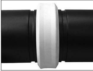
**5. JOINDRE LES PIÈCES DE RACCORDEMENT :** Aligner et joindre les deux extrémités des pièces de raccordement. Faire glisser le joint d'assemblage en place en le centrant entre les rainures de chaque extrémité des pièces à raccorder. **REMARQUE :** s'assurer qu'aucune partie du joint d'assemblage n'entre dans la rainure de l'une ou l'autre des pièces de raccordement.
