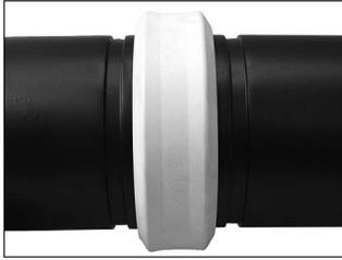
**5. ASSEMBLAGE DES ÉLÉMENTS À ASSEMBLER :** Aligner et mettre les extrémités des deux éléments à assembler bout à bout. Faire glisser l'ensemble d'étanchéité en position, à savoir centré entre les rainures des extrémités de chaque élément à assembler. **REMARQUE :** Vérifier qu'aucune partie de l'ensemble d'étanchéité ne déborde dans la rainure de l'un des éléments à assembler.
