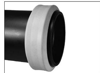
**4. COLOCACIÓN DE LA JUNTA:** Coloque la junta en el extremo del componente a unir. Verifique que la junta no sobresalga del extremo del componente a unir. **NOTA:** La temperatura de la junta debe ser igual o mayor que la del componente a unir para asegurar una instalación correcta y evitar daños en la junta.
