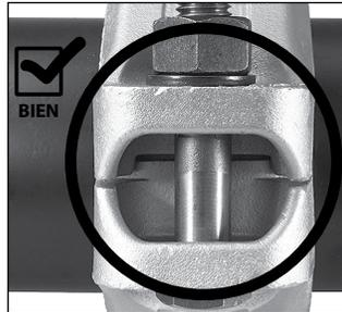
**10. INSPECCIÓN DE LAS UNIONES EMPERRADAS:** Inspeccione las uniones emperradas de cada unión para asegurarse de que el montaje sea correcto. Las tuercas se deben apretar aplicando el par de apriete indicado en la tabla siguiente. Además, la separación en ambas uniones emperradas debe ser relativamente uniforme (la suma de la separación de ambas uniones no debe superar el valor indicado en la tabla siguiente).
