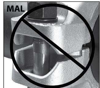
**SEPARACIÓN DEMASIADO GRANDE EN UNA UNIÓN EMPERRADA (LA UNIÓN EMPERRADA DEL LADO OPUESTO PUEDE ESTAR DEMASIADO APRETADA, DEBIDO A QUE NO SE HA ALTERNADO DE FORMA CORRECTA ENTRE AMBAS UNIONES DURANTE EL APRIETE)**
