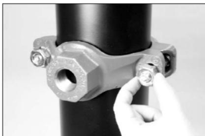
**4. INSTALE EL PERNO/TUERCA RESTANTE:** Inserte el perno restante. Enrosque una tuerca en el perno apretando con la mano. Asegúrese de que las cabezas de los pernos de posicionamiento fijo se asienten correctamente en los orificios para pernos.
