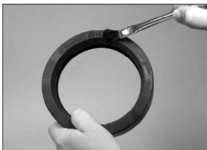
**4. LUBRIQUE LA EMPAQUETADURA:** Revise la empaquetadura para verificar si es apta para el servicio que prestará. El código de colores identifica la clase de empaquetadura. Lubrique la empaquetadura como se indica en la tabla “Compatibilidad de lubricantes para empaquetaduras” en la página 26. Siempre consulte los requerimientos de compatibilidad del lubricante con el fabricante de la tubería.
