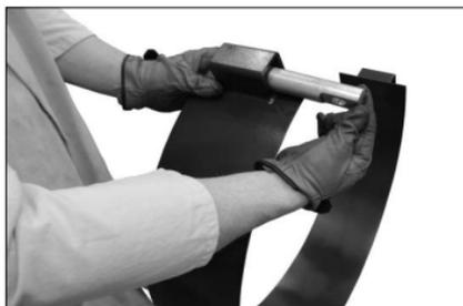
**1. INSERTE EL PASADOR:** Inserte el pasador por el soporte de retención en ambos lados de la banda. La cara plana del pasador debería apuntar hacia al lado opuesto del extremo abierto de la banda, como se muestra en la siguiente vista de perfil a la derecha.
