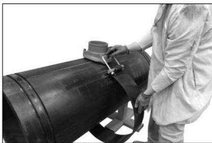
**7. POSICIONE LA BANDA:** Tome un extremo de la banda de sujeción bajo la tubería y enganche el perno en “U” en el refuerzo de retención del bastidor de la espiga.
