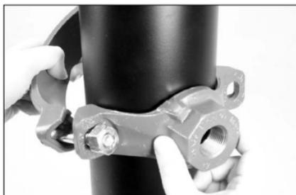
**3a. INSTALE LOS SEGMENTOS:** Haga girar el segmento inferior para posicionarlo a unos 90° respecto del segmento superior (salida), como se muestra arriba. Coloque el segmento superior (salida) sobre la cara de la tubería, alineado con el orificio de salida cortado en la tubería. Haga girar el segmento inferior alrededor de la tubería.
