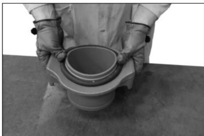
**5. INSTALE EL O-RING:** Presione el O-ring en la ranura en el lado inferior del bastidor de la espiga. NO coloque el O-ring en la tubería para luego empujar el cuello de posicionamiento sobre él. Esto podría empujar al O-ring al interior del orificio e impedir un sello adecuado.
