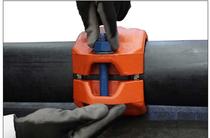
5. Mettre en place les boulons et les rondelles (une rondelle en acier carbone ou deux rondelles en acier inoxydable pour chaque écrou dans les diamètres de 2 – 4 pouces et 63 – 110 mm, deux rondelles pour chaque écrou dans les diamètres de 5 – 14 pouces et 125 – 355 mm). Visser manuellement un écrou sur chaque boulon.
