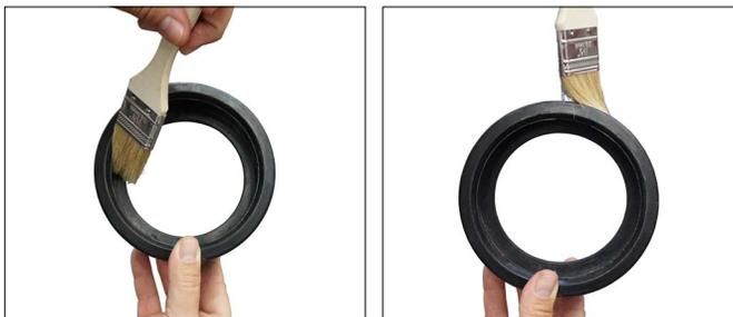
Appliquer une mince couche de lubrifiant compatible sur les lèvres et la partie extérieure du joint, juste avant de le remonter. Lubrifier le joint comme indiqué au Tableau 2. Toujours se renseigner auprès du fabricant pour connaître les exigences de compatibilité des lubrifiants.
