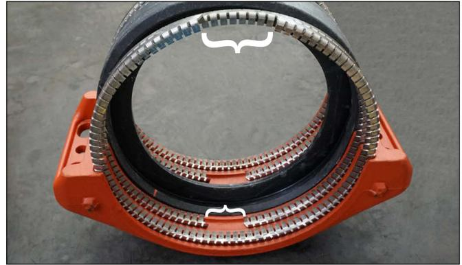
4b. En medidas de 10 pulg/250 mm y mayores, los retenes dobles se deben instalar con espacios a grados unos de otros, en las posiciones 6:00 y 12:00, como en la ilustración.
