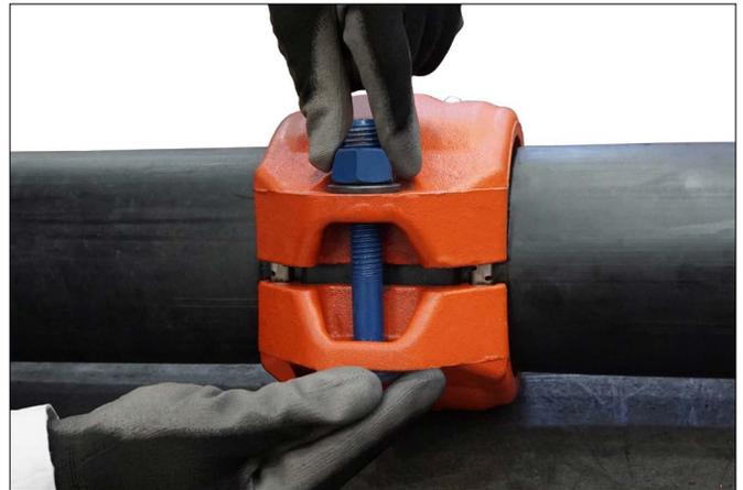
5. Instale tornillos y arandelas (una arandela de acero al carbono o dos arandelas de acero inoxidable debajo de cada tuerca en medidas de 2 – 4 pulg y 63–110 mm, dos arandelas debajo de cada tuerca en medidas de 5 – 14 pulg y 125 – 355 mm). Enrosque una tuerca en cada tornillo a mano.
