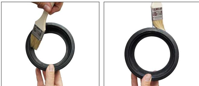
Aplique una fina capa de lubricante sobre los labios y el exterior de la junta justo antes de instalarla. Lubrique la junta conforme a la Tabla 2. Consulte siempre con el fabricante si el lubricante es compatible.
