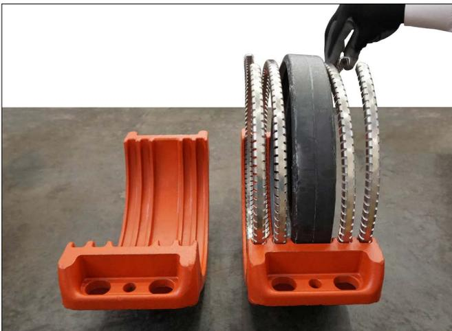
4a. Monte el acoplamiento en la configuración 'Installation Ready' instalando junta y retenes en una carcasa, como arriba, y coloque la segunda carcasa por encima. Compruebe que junta y retenes queden bien metidos en sus respectivas bolsas.
