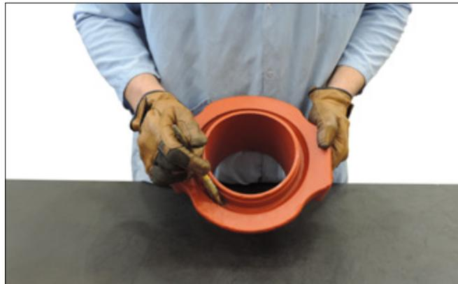
**5. INSTALLER LE JOINT TORIQUE :** Presser le joint torique dans la rainure en-dessous du corps du raccord de dérivation. Ne PAS placer le joint torique sur le tuyau et insérer ensuite le collet de positionnement dans celui-ci en tentant d'insérer le joint dans la rainure. Cette méthode pourrait repousser le joint torique dans le trou prévenant toute étanchéité.
