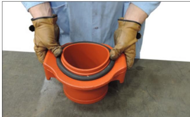
**6. METTRE LE RACCORD EN PLACE :** Mettre le corps du raccord en place en insérant le collet de positionnement dans le trou du tuyau. S'assurer que le joint torique demeure dans la rainure du raccord sans se déloger ou tomber dans le trou.
