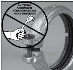
**1. NEHMEN SIE DIE KUPPLUNG NICHT AUSEINANDER:** Die starren Installation-Ready™ Kupplungen des Typs E497 sind so konzipiert, dass der Monteur die Schrauben und Muttern für die Installation nicht entfernen muss. Dies erleichtert die Installation, da der Monteur das genutete Ende der Gegenstücke direkt in die Kupplung einführen kann.
