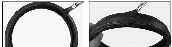
**5. SCHMIERN SIE DIE DICHTUNG FÜR DIE ERNEUTE MONTAGE VON KUPPLUNGEN DES TYP S E497:** Tragen Sie eine dünne Schicht eines verträglichen Schmiermittels wie z. B. Victaulic Schmiermittel oder Silikonfett auf die Dichtlippen und die Außenseite der Dichtung auf (Silikonspray ist kein verträgliches Schmiermittel). Bei wiederverwendeten Dichtungen ist es normal, dass die Oberfläche der Dichtung trüb weiß ist, wenn sie bereits im Einsatz war.
