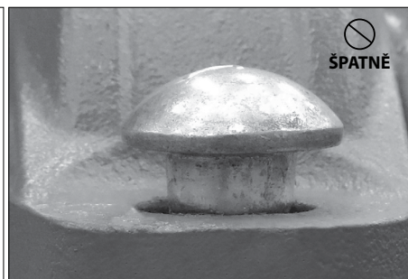
ŠPATNÝ ZÁBĚR ŠROUBU (OVÁLNÝ KRK KAŽDÉHO ŠROUBU NESEDÍ SPRÁVNĚ V OTVORU PRO ŠROUB)
