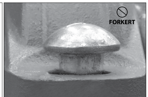
FORKERT BOLTMONTERING (DEN OVALE HALS SIDDER IKKE KORREKT I BOLTHULLET)
