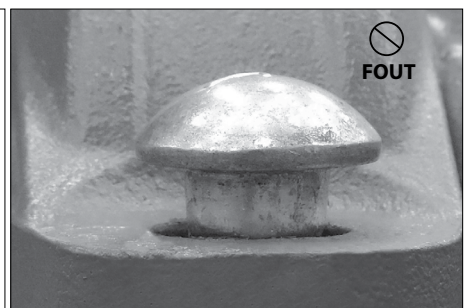
FOUTE BOUTBEVESTIGING (DE OVALE NEK ZIT NIET JUUST IN HET BOUTGAT)
