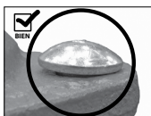
CUELLO OVAL DEL PERNO ASENTADO CORRECTAMENTE
