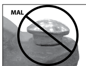
CUELLO OVAL DEL PERNO NO ASENTADO CORRECTAMENTE
