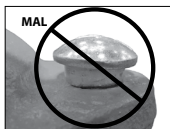
CUELLO OVAL DEL PERNO NO ASENTADO CORRECTAMENTE
