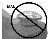
CUELLO OVAL DEL PERNO ASENTADO INCORRECTAMENTE
