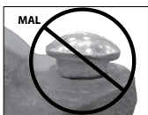
CUELLO OVAL DEL PERNO NO ASENTADO CORRECTAMENTE
