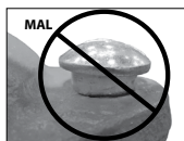
CUELLO OVAL DEL PERNO ASENTADO INCORRECTAMENTE
