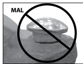
MAL CUELLO OVAL DEL PERNO ASENTADO INCORRECTAMENTE
