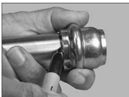
2. Lorsque le tuyau est inséré complètement dans le gabarit, marquer le tuyau le long de l'arête du gabarit à l'aide d'un marqueur ou d'un bâton de peinture, tel qu'illustré ci-dessus.
