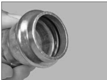
**1.** Vérifier les orifices des produits du système Vic-Press Schedule 10S pour s'assurer que les joints d'étanchéité sont placés correctement dans la gorge d'étanchéité. Vérifier que les joints sont fabriqués avec un matériau qui convient à l'usage prévu.
