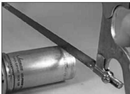
3. A l'aide d'une scie, commencer la coupe sur le trait de scie de l'extrémité. **REMARQUE** : le trait de scie de coupe d'extrémité est situé à un endroit précis. **NE PAS** couper le bouchon profond à un autre endroit que celui-ci. Cet endroit est important pour le montage adéquat du raccord Vic-Press Schedule 10S adjacent.
