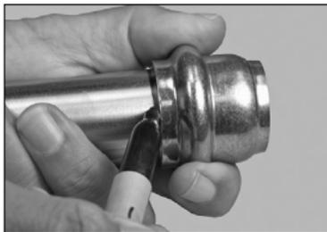
2. Com o tubo completamente inserido no medidor de marcação, marque o tubo ao longo da borda do medidor com um marcador ou um craião, como mostrado acima.
