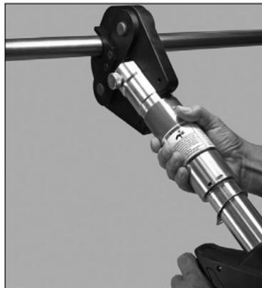
4. Certifique-se de que as marcas no tubo indicam a inserção completa no acoplamento ou no encaixe antes de efetuar a operação de prensagem.
