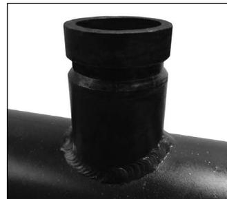
**2. CONTROLLARE L'ESTREMITÀ SCANALATA DELLA TUBAZIONE DEGLI UGELLI:** La superficie esterna della tubazione degli sprinkler, tra la scanalatura e l'estremità della tubazione stessa, dovrà essere priva di rientranze, sporgenze, cordoni di saldatura e segni di rullatura, per assicurare una tenuta ermetica. Si dovrà rimuovere qualsiasi traccia di olio, grasso, scaglie di vernice, residui di taglio e sporcizia.
