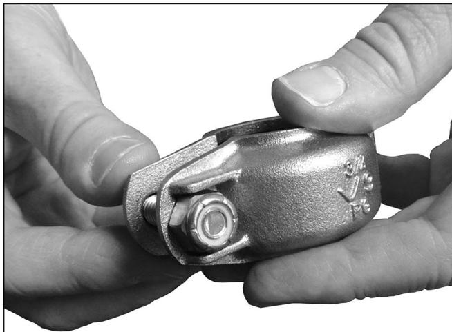
**8. INSTALLAZIONE DEL DADO:** Avvitare il bullone sul dado fino a quando la parte superiore del dado è a filo con l'estremità del bullone, come mostrato sopra. Verificare che la guarnizione rimanga inserita nella sede del guscio e che il dado sia impegnato nelle sezioni piatte della battuta del bullone.
