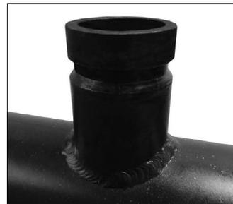
**2. REVISE EL EXTREMO RANURADO DE LA TUBERÍA DEL ROCIADOR:** En general, la superficie exterior de la tubería del rociador, entre la ranura y el extremo, no deberá presentar abolladuras, salientes, anomalías de costura, ni estampado de laminación para obtener un sello hermético. Se debe remover todo el aceite, la grasa, la pintura suelta, la suciedad y las virutas de corte.
