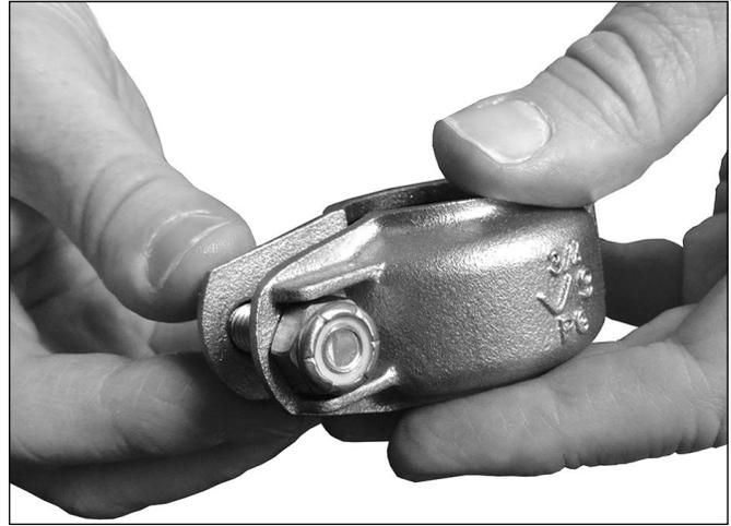
**8. INSTALE LA TUERCA:** Enrosque el perno en la tuerca hasta que la parte superior de la misma quede a ras con el extremo del perno, como se muestra arriba. Verifique que la empaquetadura permanezca asentada en la cavidad de los segmentos y que la tuerca esté en contacto con el perfil plano del cierre.
