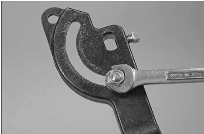
3. 如上图所示，松开记忆定位硬件的六角螺母。
