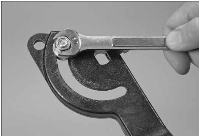
4. 如上图所示，移动记忆定位硬件到凹槽的相反端头。拧紧六角螺母，防止重新安装杠杆锁手柄时硬件移动。
