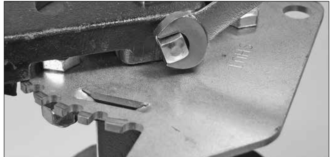
7. 如上图所示，拧紧固定螺钉在手柄的侧面。
