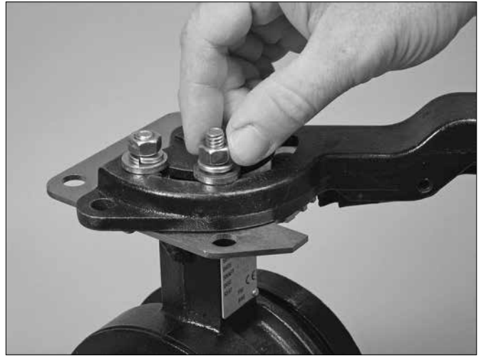
6. 重新安装平垫片、锁紧垫片和六角螺母在六角头螺钉上，如上图所示。拧紧六角螺母，直到锁紧垫片压紧。
