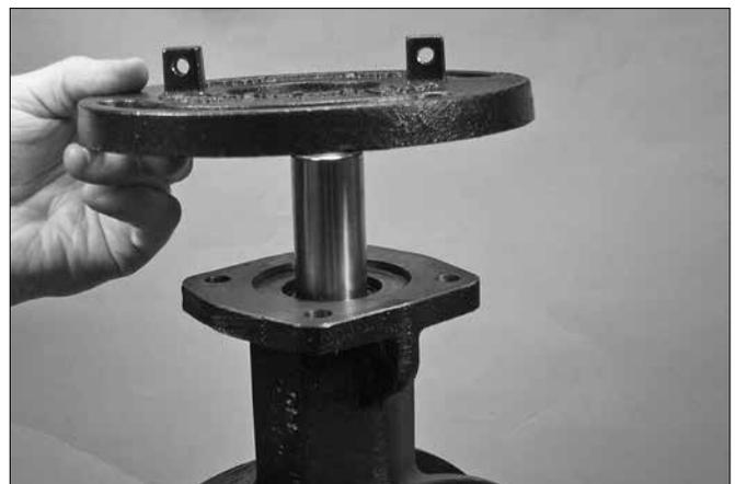
1. Bringen Sie die Einstellscheibe (Pos. 1) so auf dem Ventil an, dass die Bohrungen der Scheibe mit den Bohrungen im Ventilgehäuse-Montageflansch übereinstimmen.
