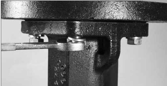
3. Verwenden Sie einen Schraubenschlüssel, um die vier Sechskantschrauben so lange gleichmäßig festzuziehen, bis die Sicherungsscheiben zusammengedrückt werden.
