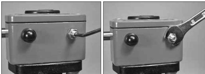
5. Ziehen Sie die Inbuseinstellschraube mit einem Inbusschlüssel (im Uhrzeigersinn) so lange an, bis sie mit dem internen Quadrantantrieb in Kontakt kommt.
