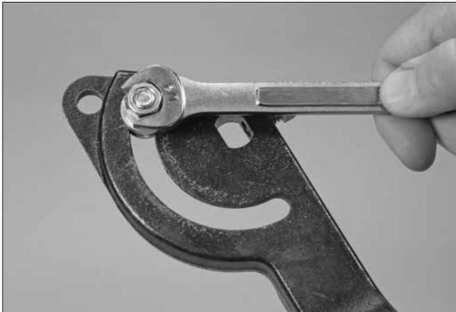
4. Bewegen Sie die Metallteile des gespeicherten Stopps wie oben dargestellt an das gegenüberliegende Ende der Aussparung. Ziehen Sie die Sechskantmutter fest, um zu verhindern, dass sich die Hardware beim Wiederanbringen des Rasterhebels bewegt.
