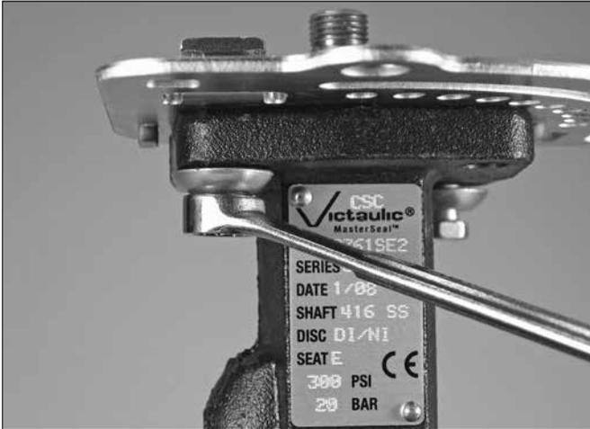
5. Ziehen Sie die Abreißsicherheitsschrauben (Pos. 9) ganz an, bis der Sechskantteil abbricht und ein mit der Oberfläche bündiger, manipulationssicherer Kopf zurückbleibt.
