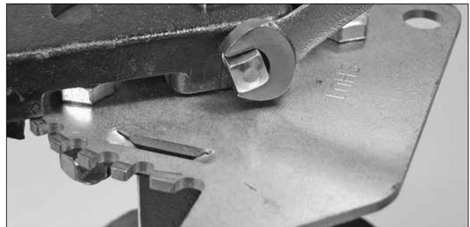
7. Ziehen Sie die Einstellschraube, die sich an der Seite des Hebels befindet, wie oben dargestellt, fest.
