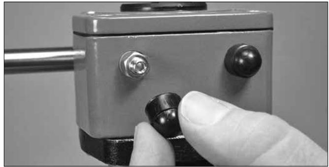
1. Entfernen Sie die sich auf der linken Seite des Antriebs befindliche Staubkappe.
