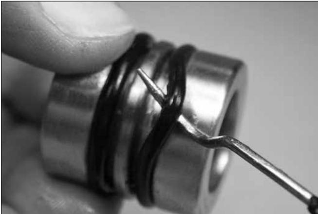
7. Verwenden Sie ein O-Ring-Entfernungswerkzeug oder ähnliches, um die zwei internen und die zwei externen O-Ringe von der Dichtungspatrone zu entfernen.
