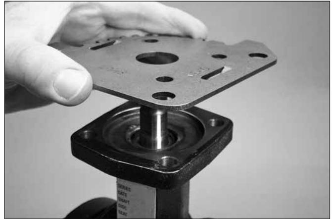
4. Entfernen Sie die Platte (Pos. 2) vom Ventilgehäuse-Montageflansch.
