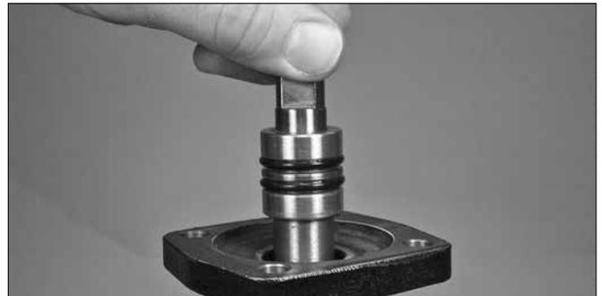
13. Führen Sie die Schaftbaugruppe in das Ventilgehäuse/die Klappenscheibe ein. Stellen Sie sicher, dass das rechteckige Ende der Klappenscheibe mit dem Schaft fluchtet. **ANMERKUNG:** Die Dichtungspatrone muss vollständig im Ventilgehäuse sitzen.
