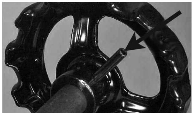
**ANMERKUNG:** Bei Absperrklappen der Serien 761 und 461 in den Größen 10"/273,0 mm und 12"/323,9 mm ist das Handrad nicht am Schaft angebracht. Richten Sie zum Anbringen des Handrads am Schaft die Bohrungen im Handrad mit den Bohrungen im Schaft aus. Schlagen Sie den (mitgelieferten) Spannstift vollständig in das Handrad und den Schaft hinein.
