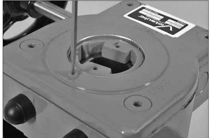
2. Entfernen Sie die sich auf der Oberseite des Antriebs befindliche Einstellschraube, wie oben dargestellt.
