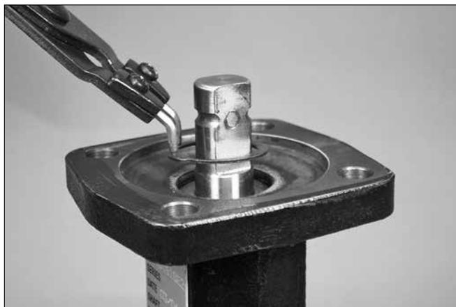
4. Benutzen Sie eine Zange oder ein ähnliches Werkzeug, um den Haltering, wie oben dargestellt, um die Schaftbaugruppe herum zu entfernen. Falls der Haltering verbogen ist und nicht mehr seine ursprüngliche Form aufweist, ersetzen Sie ihn durch einen neuen Haltering von Victaulic.
