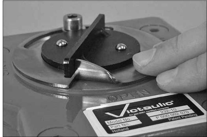
7. Schieben Sie den flachen Teil des gespeicherten Stops mit dem Ansatz in Richtung der Positionsanzeige, bis die beiden Teile in Kontakt kommen.
