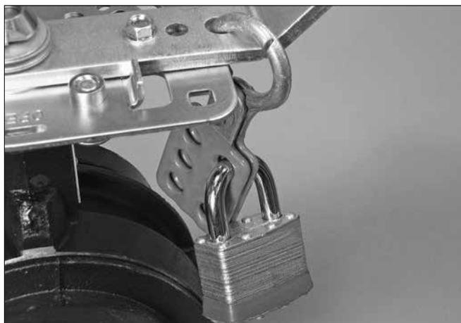
**ANMERKUNG:** Das Ventil kann nun mittels eines Vorhängeschlosses in der geöffneten oder geschlossenen Stellung arretiert werden.
