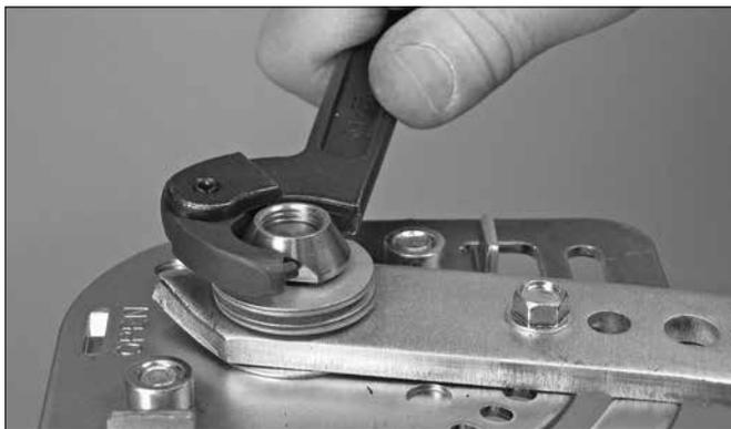
10. Ziehen Sie die manipulationssichere Mutter (Pos. 5) mit einem Gabelschlüssel vollständig an.
