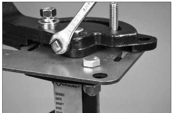
2. Lösen Sie die Einstellschraube an der Seite des Hebels, wie oben dargestellt.
