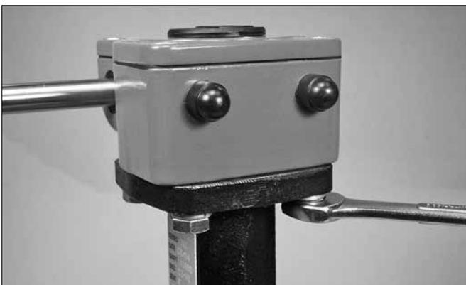
4. Verwenden Sie einen Schraubenschlüssel, um die vier Sechskantschrauben gleichmäßig solange festzuziehen, bis die Sicherungsscheiben zusammengedrückt werden.
