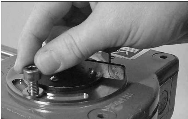
6. Führen Sie die Schraube mit der Unterlegscheibe in die Gewindebohrung im Antrieb ein. Ziehen Sie die Schraube zu diesem Zeitpunkt noch nicht ganz an. Drehen Sie das Handrad, um die Klappenscheibe in die gewünschte Position zu bringen (im Uhrzeigersinn, um sie zu schließen, gegen den Uhrzeigersinn, um sie zu öffnen).
