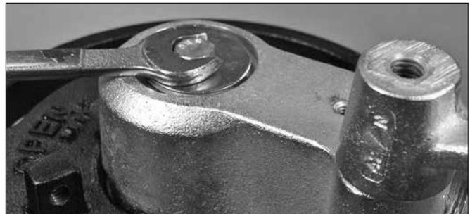
7. Befestigen Sie die Hebelnabe wie oben dargestellt mit der Unterlegscheibe (Pos. 11) und der Sechskantschraube (Pos. 8) auf dem Schaft.
