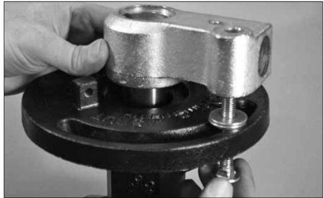
5. Stellen Sie sicher, dass die Klappenscheibe des Ventils sich in der „OPEN“ (geöffneten) Stellung befindet. Führen Sie die Schlossschraube (Pos. 14) durch die Unterseite der Einstellscheibe nach oben ein. Platzieren Sie die zwei Unterlegscheiben (Pos. 10) auf der Schlossschraube.
