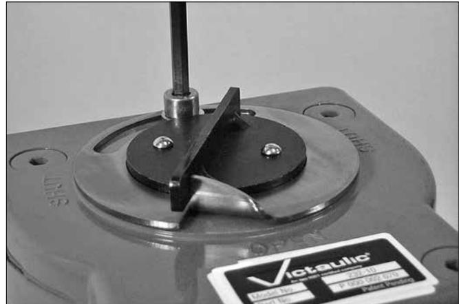
8. Ziehen Sie die Schraube nun vollständig an, um den gespeicherten Stopp in seiner Position zu arretieren.
