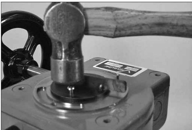
5. Führen Sie die Mitnehmerstifte in die Bohrungen der Positionsanzeige und des Antriebs ein. Schlagen Sie die Mitnehmerstifte in den Antrieb hinein.
