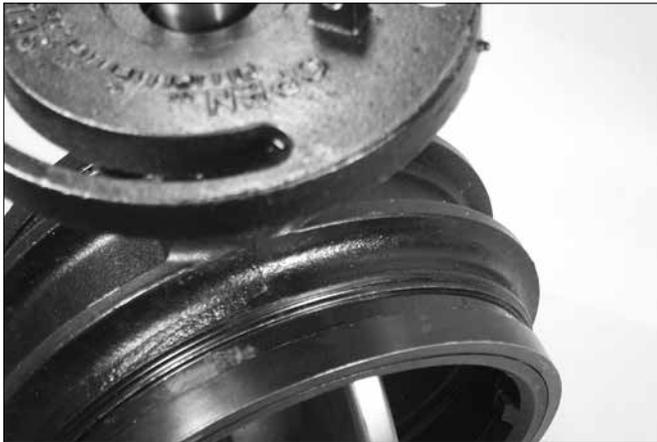
1a. Stellen Sie sicher, dass die „OPEN“ (offen)-Markierungen mit dem Einlass und dem Auslass des Ventils übereinstimmen.
