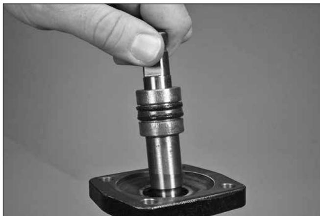
5. Entfernen Sie die Schaftbaugruppe von der Klappenscheibe/ vom Ventilgehäuse. Achten Sie dabei darauf, dass Sie die Flächen der Antriebsnabe nicht beschädigen.
