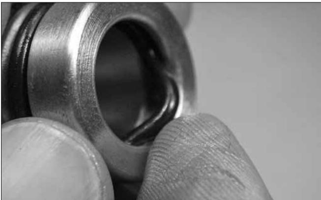
10. Setzen Sie wie oben dargestellt zwei neue O-Ringe in die Dichtungspatrone ein.
