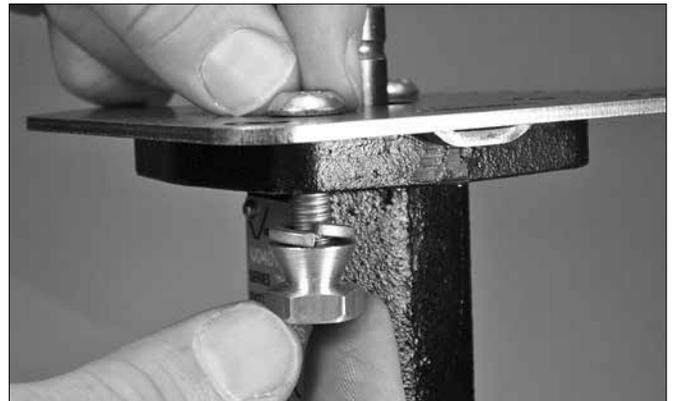
4. Führen Sie eine manipulationssichere Torx-Schraube (Pos. 4) durch die zwei Bohrungen in der Platte und in den Ventilgehäuse-Montageflansch ein. Platzieren Sie auf den Enden aller manipulationssicheren Torx-Schrauben eine Sicherungsscheibe (Pos. 5) und schrauben Sie eine manipulationssichere Mutter (Pos. 6) auf die Enden aller Torx-Schrauben und ziehen Sie sie handfest an. Ziehen Sie die Torx-Schrauben zu diesem Zeitpunkt noch NICHT ganz an.
