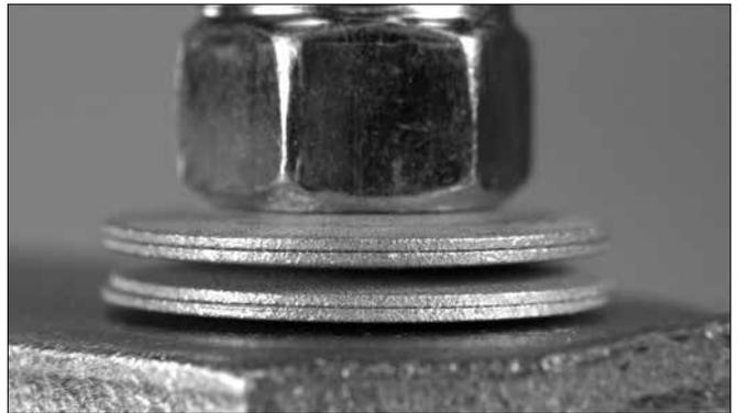
15. Installieren Sie die vorhandenen Federscheiben auf dem Schaftadapter (Pos. 2). Stellen Sie sicher, dass die Federscheiben-Sets so installiert werden, dass die äußeren Kanten in Kontakt sind, wie in obiger Zeichnung und Darstellung gezeigt.
