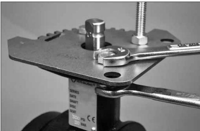
3. Entfernen Sie die Sechskantmutter (Pos. 5) und die Sicherungsscheiben (Pos. 4) von den zwei Sechskantschrauben (Pos. 3). Entfernen Sie darüber hinaus auch die Sechskantmutter (Pos. 5) und die Sicherungsscheibe (Pos. 4) von der Sechskantschraube (Pos. 6), damit die Platte vom Ventilgehäuse-Montageflansch abgenommen werden kann.
