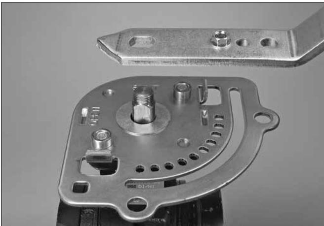
7. Platzieren Sie den manipulationssicheren Hebel (Pos. 1) auf der Schaftbaugruppe. Stellen Sie sicher, dass die Arretierungsschraube (Pos. 10) des manipulationssicheren Hebels wie oben dargestellt in Richtung der Arretierungen der Platte zeigt.
