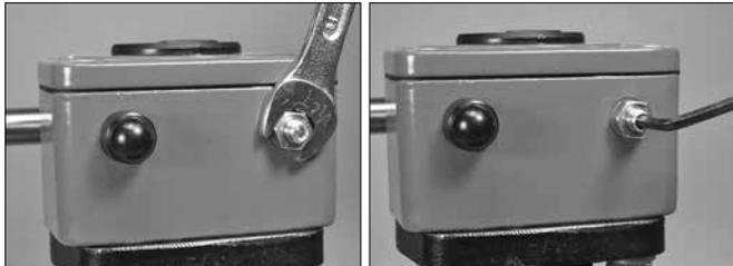
2. Lösen Sie die Sechskantsicherungsmutter auf der rechten Seite des Antriebs (gegen den Uhrzeigersinn).
