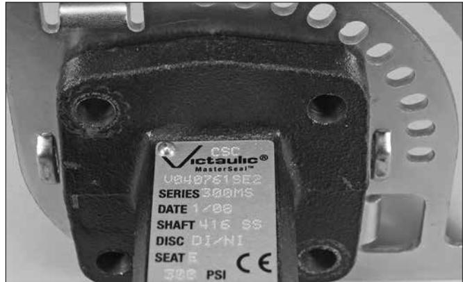
3. Installieren Sie die Platte (Pos. 2) über die Schaftbaugruppe und auf dem Ventilgehäuse-Montageflansch. Stellen Sie sicher, dass je zwei Bohrungen der Platte mit zwei Bohrungen im Ventilgehäuse-Montageflansch fluchten. **ANMERKUNG:** Wenn die Platte nicht ordnungsgemäß installiert wird, sitzt sie nicht gleichmäßig auf dem Ventilgehäuse-Montageflansch.
