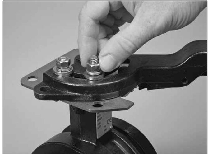
6. Bringen Sie die Unterlegscheibe, die Sicherungsscheibe und die Sechskantmutter wie oben dargestellt wieder auf der Sechskantschraube an. Ziehen Sie die Sechskantmutter so lange fest, bis Druck auf die Sicherungsscheibe ausgeübt wird.
