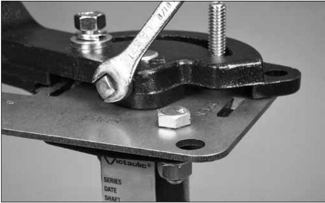
2. Lösen Sie die Einstellschraube an der Seite des Hebels (Pos. 1), wie oben dargestellt.
