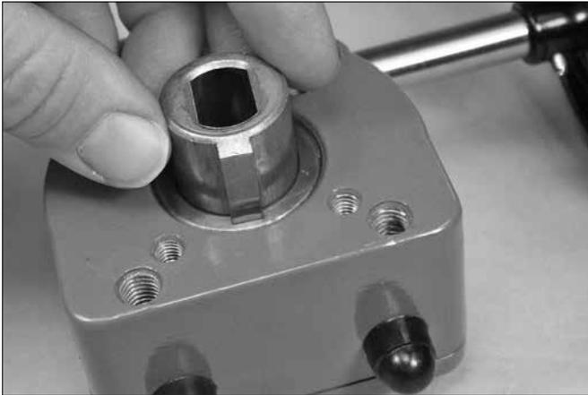
2. Führen Sie die Antriebsbuchse wie oben dargestellt in den Antrieb ein. Platzieren Sie die Antriebs-/Antriebsbuchsen-Baugruppe auf dem Ventilgehäuse, indem Sie die vier Bohrungen des Antriebs mit den vier Bohrungen im Ventilgehäuse ausrichten.
