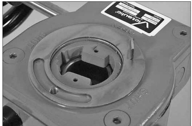
3. Bringen Sie den gespeicherten Stopp auf dem Antrieb an. Stellen Sie sicher, dass die Gewindebohrung sich wie oben dargestellt in der Mitte der Aussparung des gespeicherten Stopps befindet.
