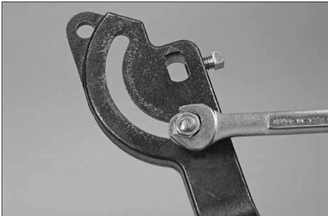
3. Lösen Sie wie oben dargestellt die Sechskantmutter der Metallteile des gespeicherten Stopps,
