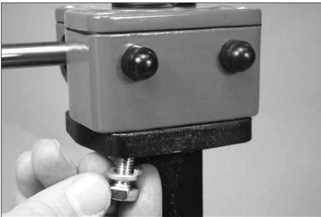
3. Bringen Sie auf jeder der vier Sechskantschrauben (Pos. 6) eine Sicherungsscheibe (Pos. 5) an. Schrauben Sie die Sechskantschrauben von unten durch die Bohrungen im Ventilgehäuse-Montageflansch und nach oben in den Antrieb ein.
