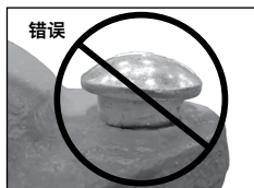
螺栓椭圆颈 未正确放置
