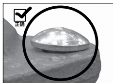
螺栓椭圆颈 已正确放置
