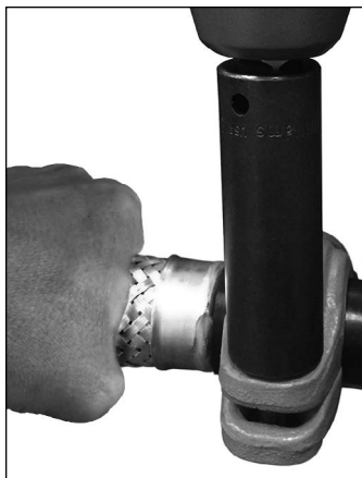
COLLET OBLONG DU BOULON MIS EN PLACE DE FAÇON INCORRECTE
