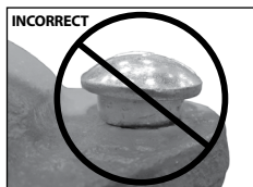
COLLET OBLONG DU BOULON MIS EN PLACE DE FAÇON INCORRECTE
