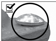
PRAWIDŁOWO OSADZONA OWALNA SZYJKA ŚRUBY
